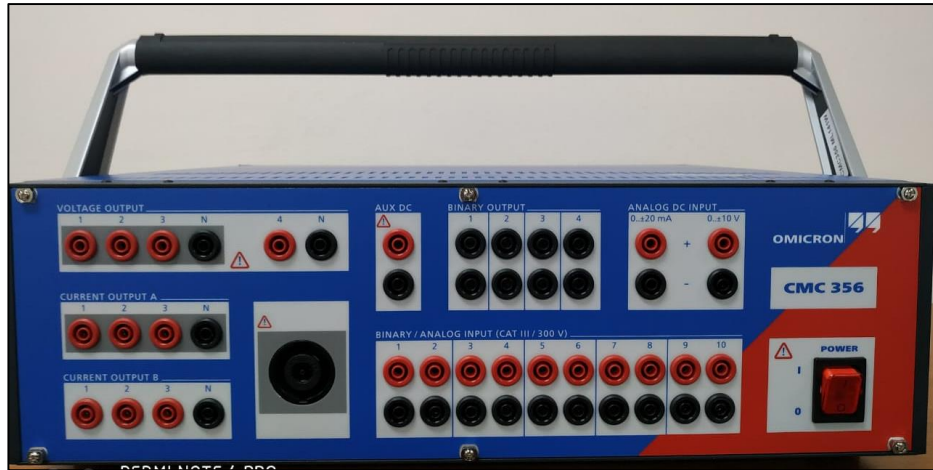
Figura 33. Unidad de pruebas de relés OMICRON CMC 356. Fuente: El autor.
