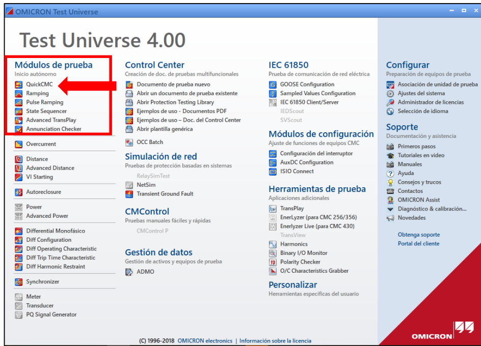
Figura 41. Pantalla principal para los módulos de prueba de relés de protecciones. Fuente: El autor.
