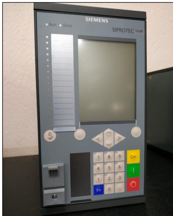
Figura 24. Relé de sobrecorriente Siemens SIPROTEC 7SJ85. Fuente: El autor.
