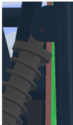
Imagen 28. Representación del sistema de suspensión sujeto en el chasis
