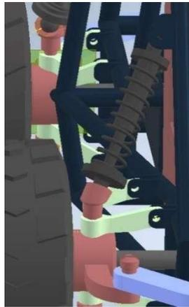
Imagen 27. Representación del sistema de suspensión sujeto en la mangueta
