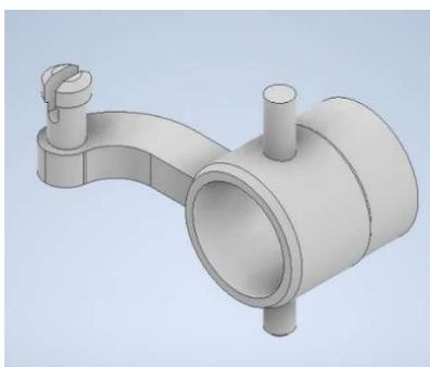
Imagen 18. Representación de la mangueta diseñada
