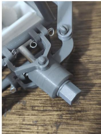
Imagen 73. Instalación de la Mangueta
