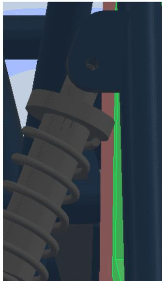
Ilustración 28. Sujeción del amortiguador
