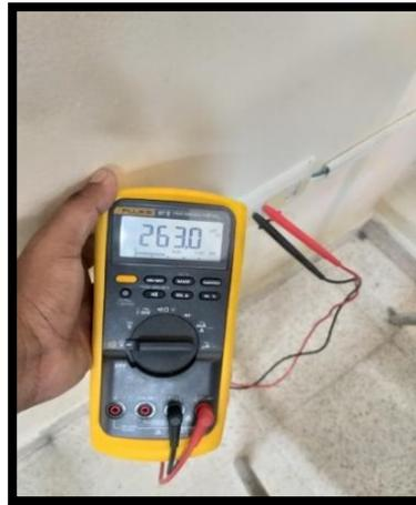
*Figura 110 Medición de tensión en sistema desenergizado*
