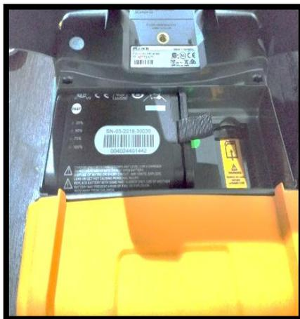
*Figura 32 Batería interna*
