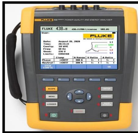
*Figura 33 Botones principales del Analizador de red*
