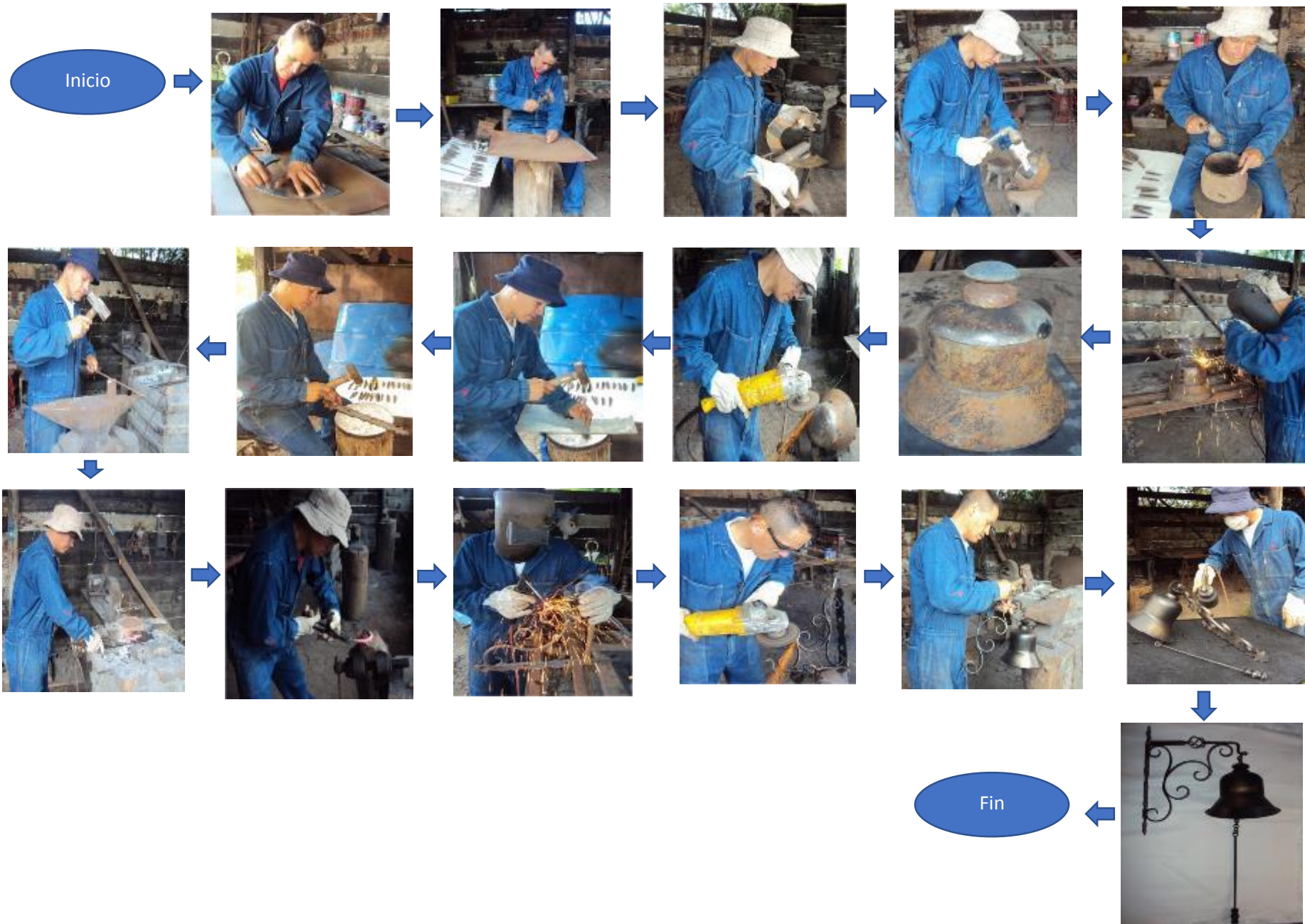
Figura N°20 Proceso de fabricación de campanas colgantes
