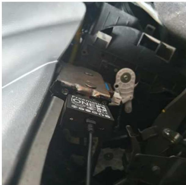
**Figura 17:** Conexión del Freematics One+ en el puerto OBD II.
