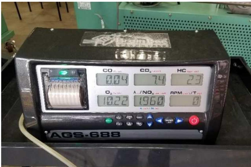
*Figura 4: Analizador de Gases Brain Bee ags-688.*
