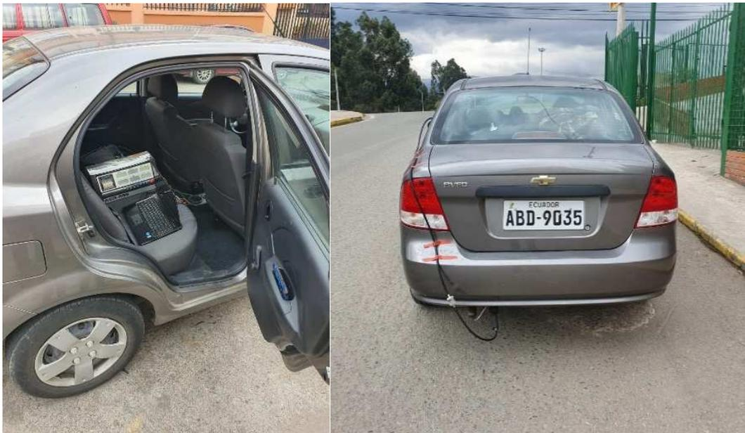
**Figura 13:** Vehículo de prueba acondicionado con los equipos de medición.
