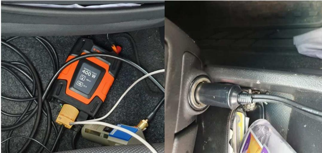
**Figura 16:** Conexión del inversor de corriente de DC a AC.
