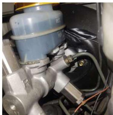
**Figura 7.** Revisión del nivel del líquido de freno
