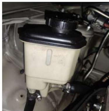
**Figura 8.** Revisión del depósito del líquido hidráulico
