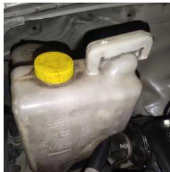
**Figura 6.** Revisión del depósito del refrigerante
