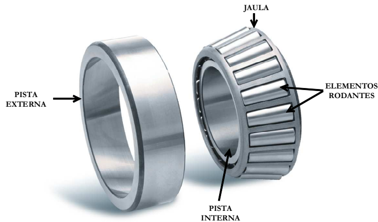
Figura 47. Componentes de un rodamiento.
