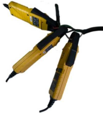
Figura 59. Conexión real de las tres pinzas amperimétricas.
