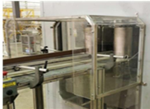
**Figura 23 Guardas en componentes de TMC**
