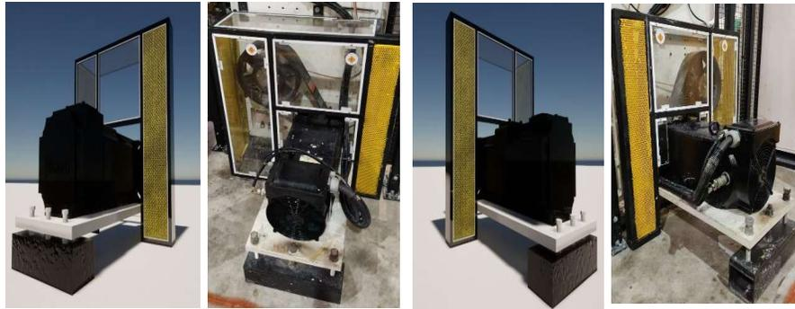
**Figura 21 Guarda fija y dispositivo de alejamiento**
