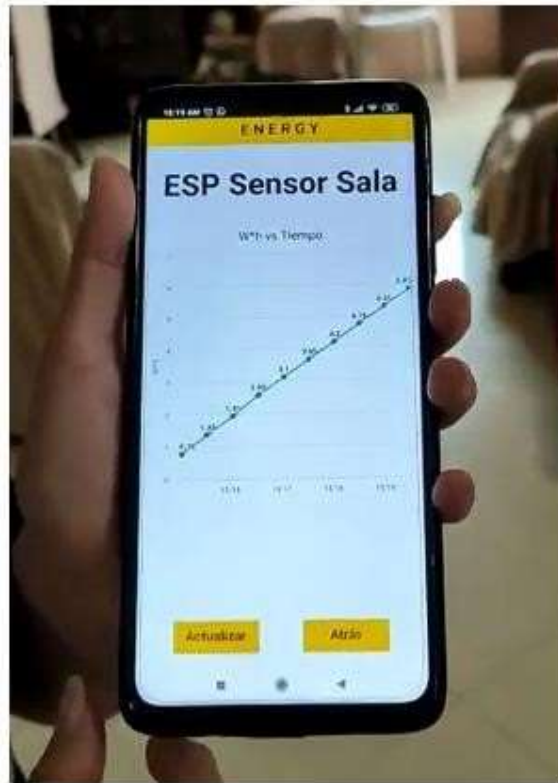
Figura 89 Valores aproximados del sensor 1 entre la aplicación y el amperímetro.
