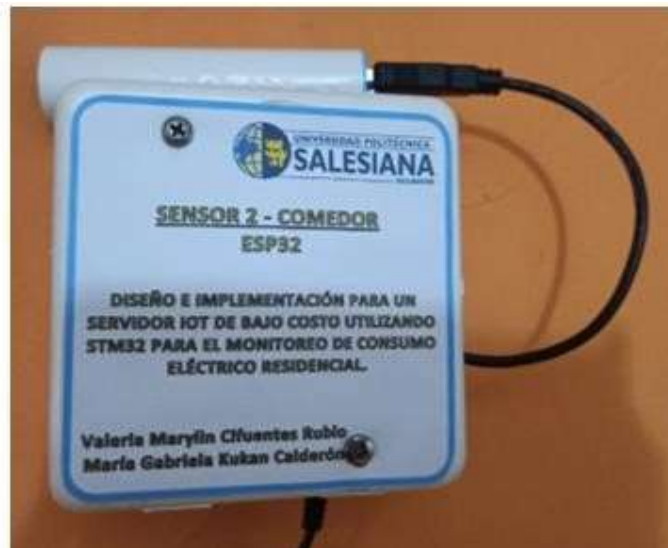
Figura 126 Funcionamiento del sensor 2 – comedor con fuente de alimentación portátil.
