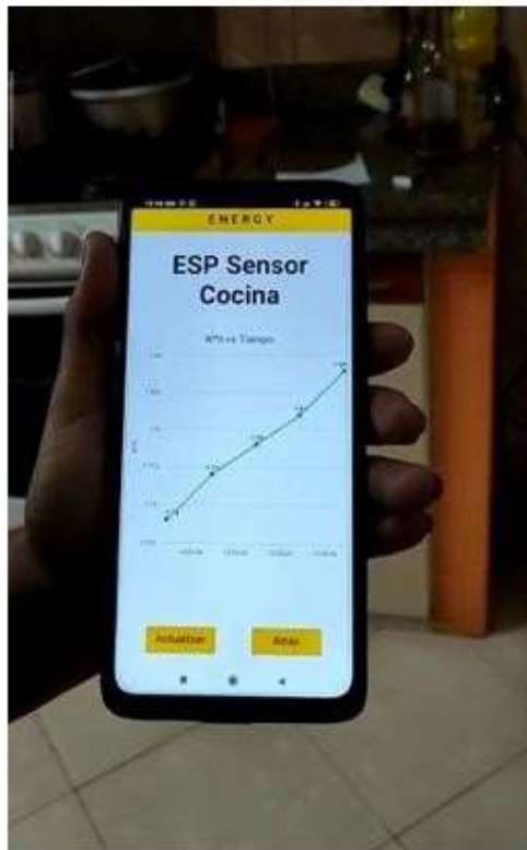
Figura 93 Valores aproximados del sensor 3 entre la aplicación y el amperímetro
