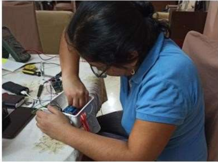
Figura 101 Ubicando en la caja el relé de 4 canales que complementara con el servidor principal.
