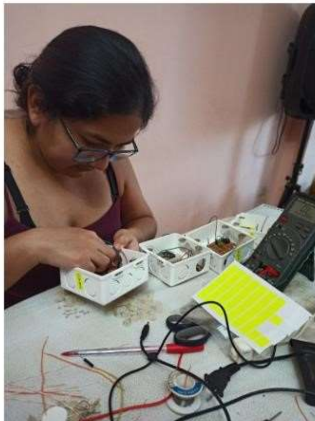
Figura 110 Colocando los elementos en sus cajas sobrepuestas de 4x4 pulgadas.
