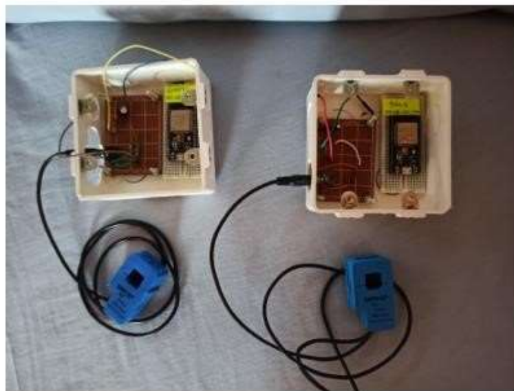
Figura 81 Las cajas con sus respectivos elementos para trabajar como sensores.
