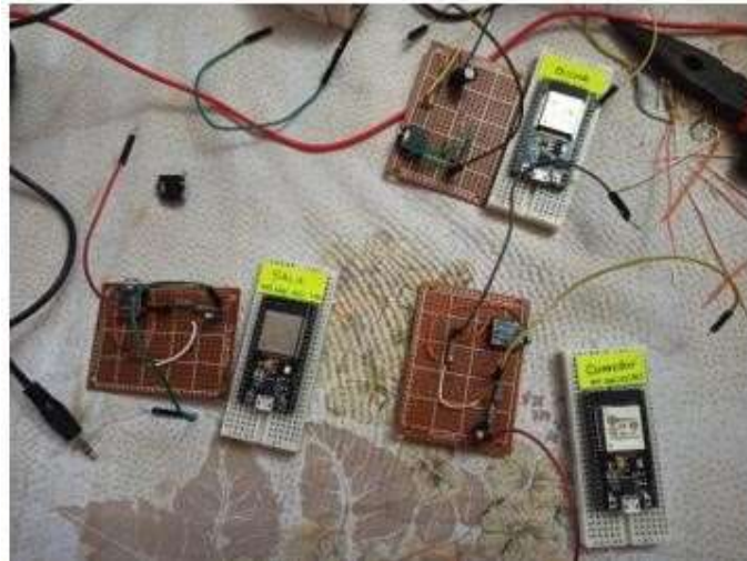
Figura 109 Los elementos ya tienen continuidad y están listos para colocarlos en sus respectivas cajas.
