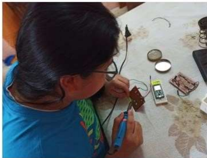
Figura 106 Soldando los elementos para los microcontroladores ESP32.
