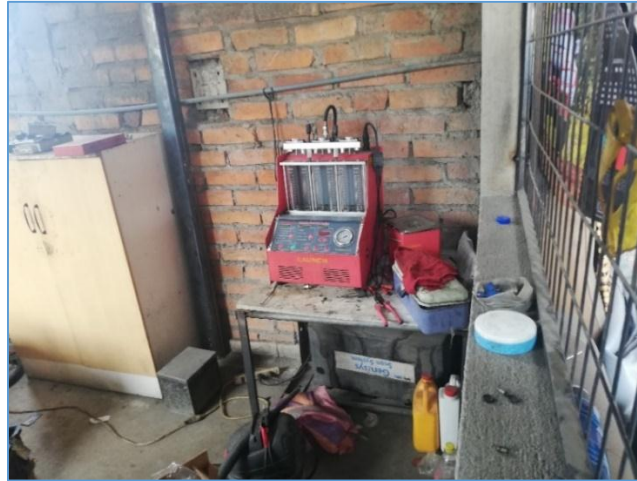
Figura 16. Ubicación de la máquina de lavado de inyectores.
