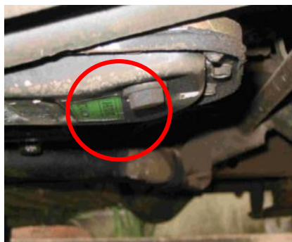
Figura 25: Tapón para el drenaje del aceite. [25]
