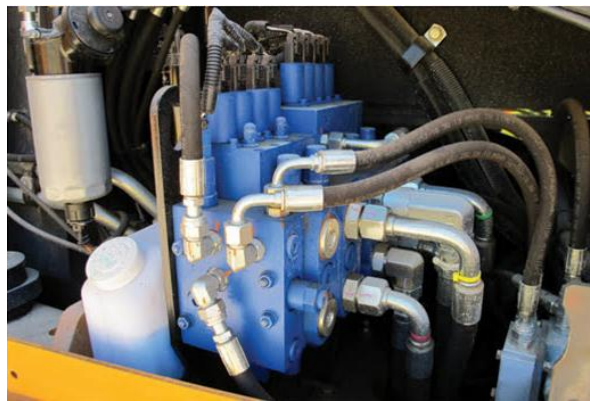
Figura 13: Conjunto de válvulas de control. [1]
