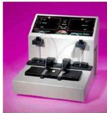
Figura 16: Equipo Ferrógrafo para muestras de aceite. [15]
