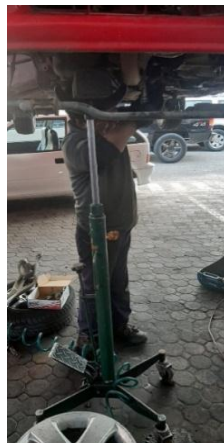
Imagen 4: Uso de gato neumático para el levantamiento de piezas con pesos superiores a los 10 kg. Fuente: Tesistas
