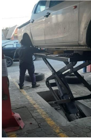
Imagen 6: Uso de elevadores hidráulicos para un ABC de frenos. Fuente: Tesistas
