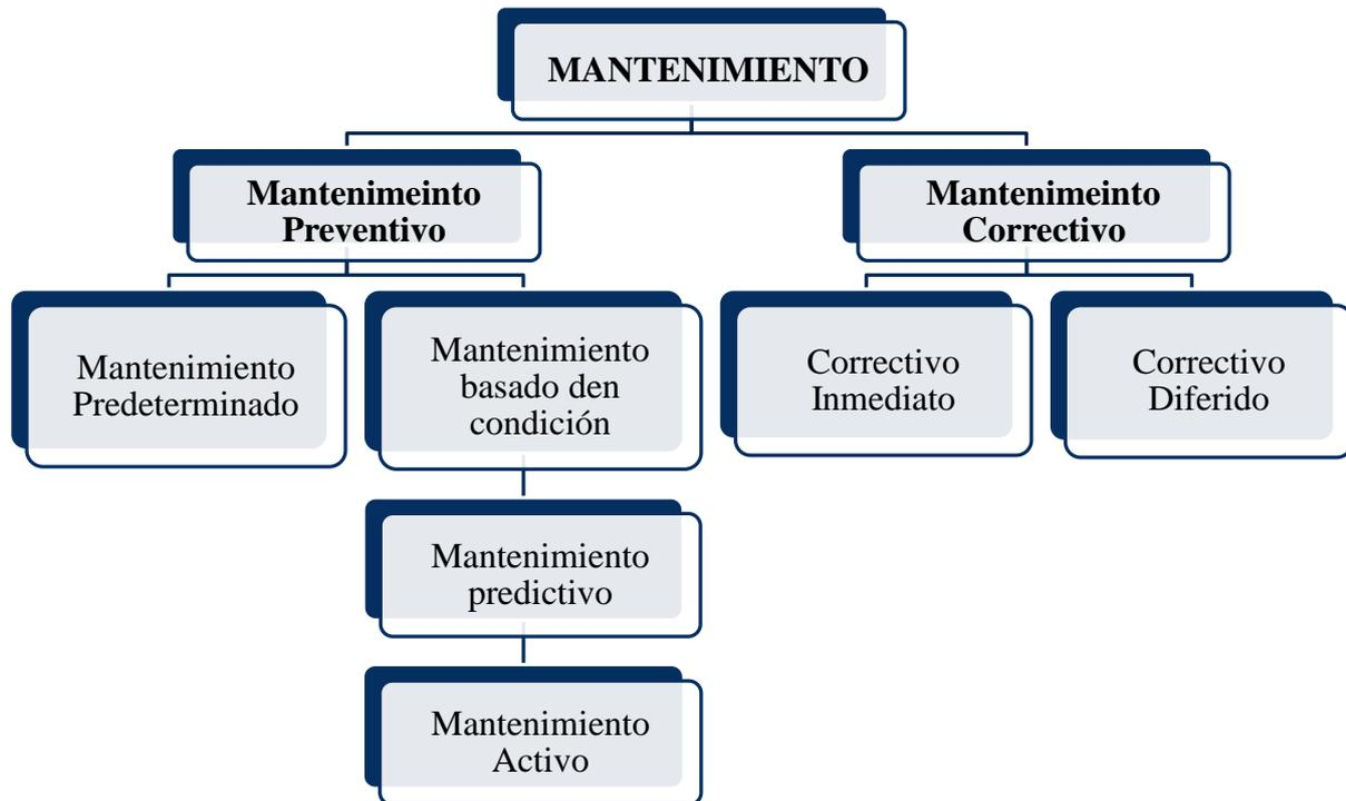
Figura 2: Clasificación del mantenimiento. Fuente: Autores
