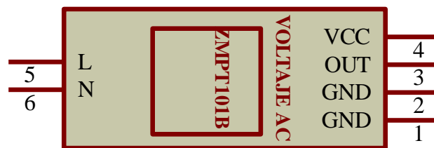
Figura 12. Sensor voltaje C- ZMPT101B Fuente: Aplicaciones IOT[18].
