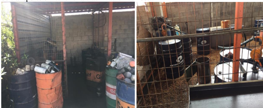
Ilustración 12: Almacenamiento de aceites y filtros usados.
