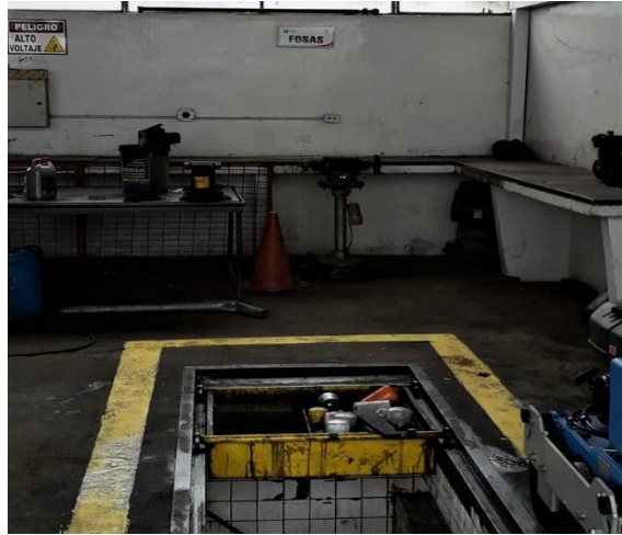
Ilustración 55: Líneas de seguridad y señalética del taller de maquinaria liviana. Fuente: Autores. (2020).
