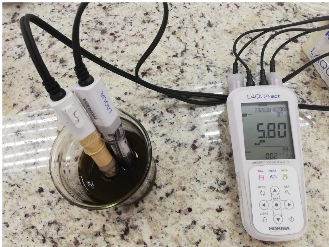
Anexo 13. Determinación del pH de la muestra de estudio en instalaciones de la UPS
