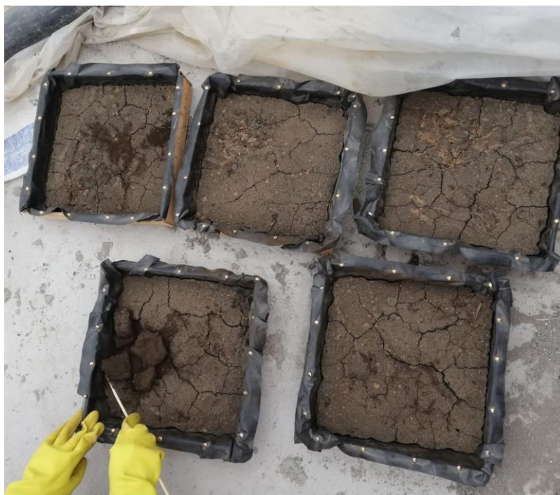
Anexo 14. Toma de muestras para análisis de contenido de humedad del tratamiento de secado solar y acondicionamiento químico respectivamente
