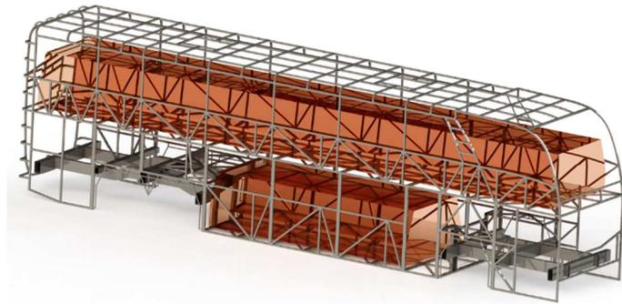
**Figura 20.** Modelado 3D del espacio de supervivencia dentro de los habitáculos del autobús.
