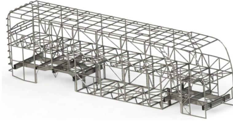
**Figura 18.** Modelado de la Estructura del Autobús de Dos Pisos.
