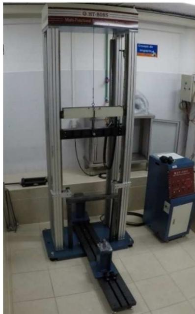
**Figura 40.** Banco de Ensayos por Impacto Mediante Caída Libre
