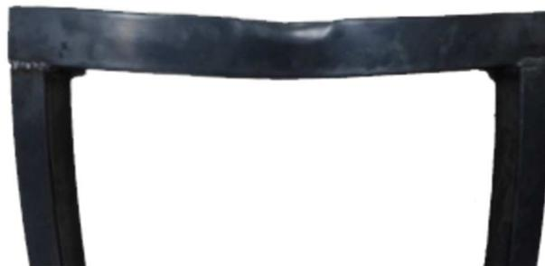
**Figura 42.** Deformación de la Probeta por Impacto
