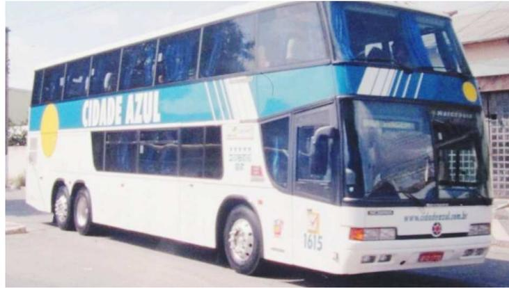
**Figura 6.** Marcopolo GV 1800 DD en chasis Scania K-112TL 6x2.
