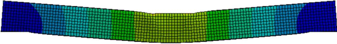
**Figura 44.** Deformación Máxima de la Probeta de Ensayo.
