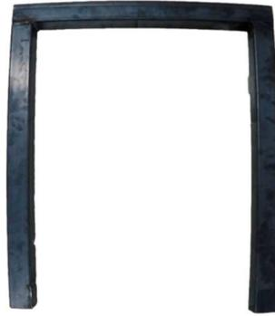
**Figura 39.** Probeta Construida para Aplicación del Ensayo de Impacto
