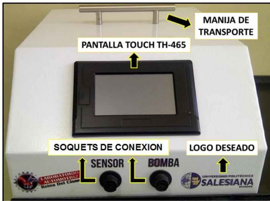
Figura 3.2a. Diagrama de descripción del prototipo de banco de pruebas.
