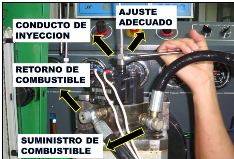
Figura 3.11. Diagrama de conexión de conductos de suministro, retorno e inyección de combustible.
