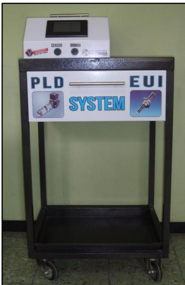
**Figura 3.1.** Diagrama de prototipo de banco de pruebas para bombas de inyección PLD y EUI.
