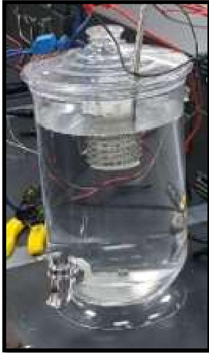
**Figura 48.** Reservorio con resistencia térmica
