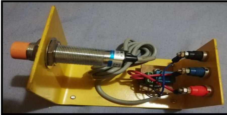
**Figura 50.** Módulo de proximidad con su respectiva conexión
