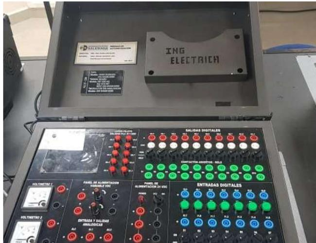
**Figura 40.** Módulo de automatización
