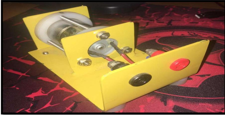
**Figura 52.** Módulo del motor reductor con su respectiva conexión
