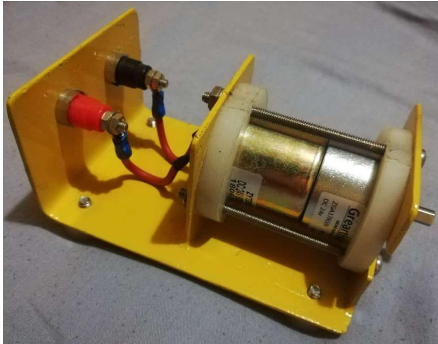
**Figura 39.** Módulo del motor de 24VDC
