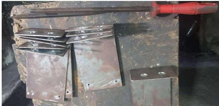
**Figura 31.** Módulos doblados para el siguiente proceso
