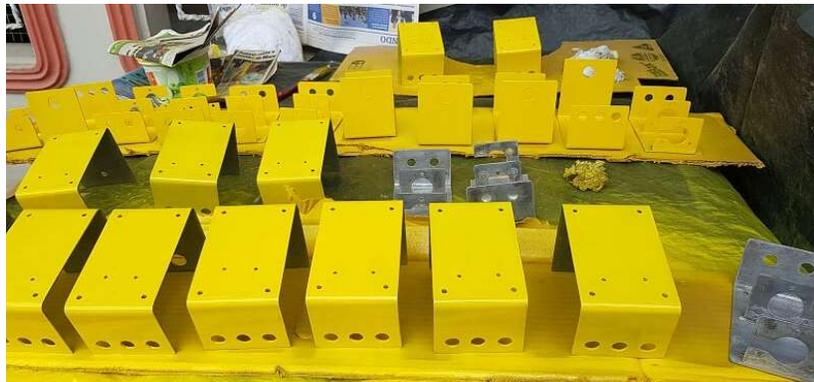
**Figura 33.** Proceso de pintado y acabado para finalizar la estructura
