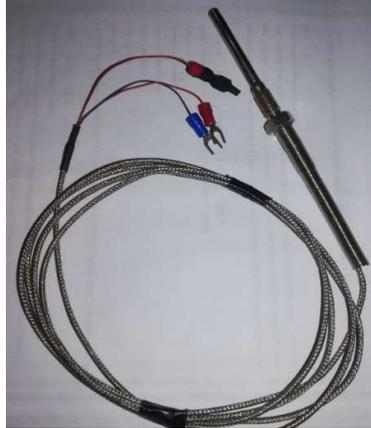
**Figura 43.** Sensor de temperatura PT100
