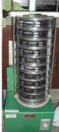
Figura 17. Tamices colocados en serie[2].
