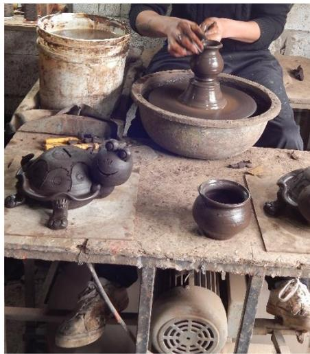
Figura 6. Moldeado del barro en platillo giratorio de madera.
