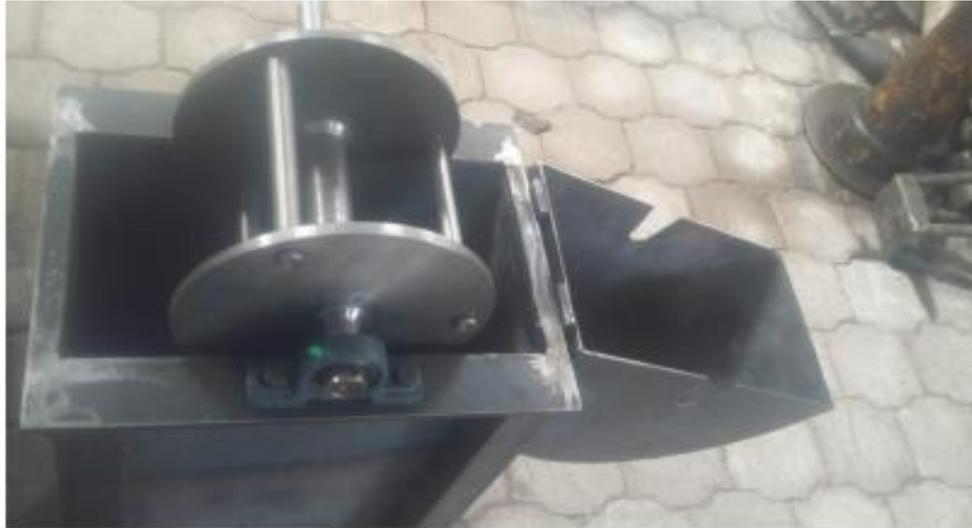
**Ensamble del rotor de la trituradora-tamizadora**
