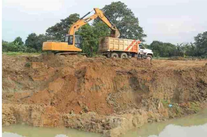
Figura 2. Extracción mecánica de arcilla[5].
