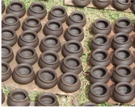
Figura 7. Secado de Figuras de barro.
