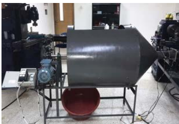
Fig. 3. Prototipo máquina fermentadora de cacao [17].
