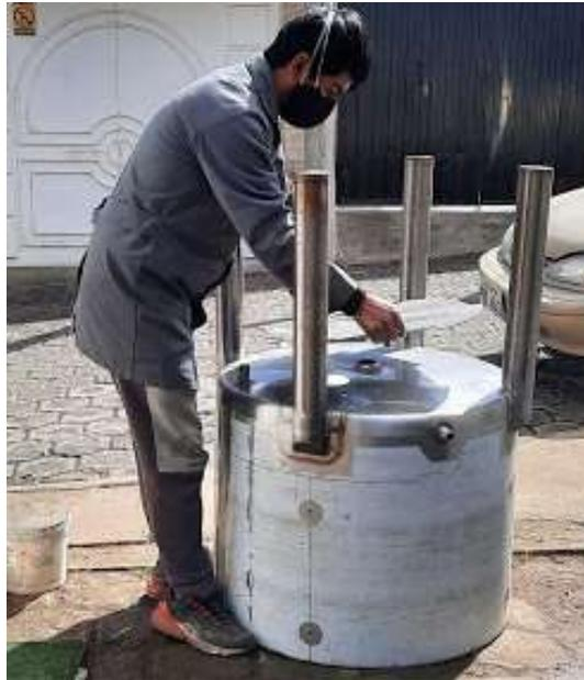
Ensamblaje tanque externo y soportes, Elaborado por: Jesús Chicaiza
