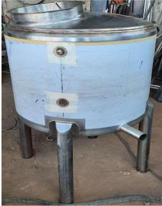
Ensamblaje tanque interno y externo pasteurizadora, Elaborado por: Jesús Chicaiza
