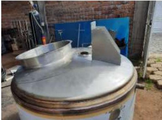
Ensamblaje base motorreductor, Elaborado por: Jesús Chicaiza
