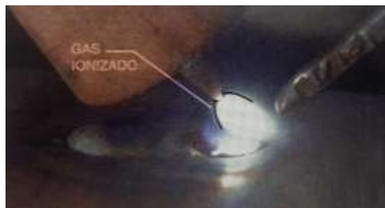
**Figura 3.** columna de gas argón ionizado altamente concentrado [36].
