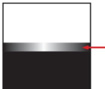
**Figura 2.** Capa de óxido de cromo adherida al metal [31].
