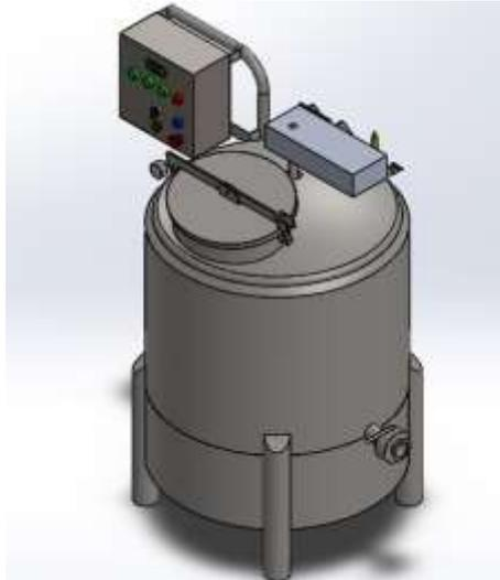
**Figura 8.** Prototipo de pasteurizadora
