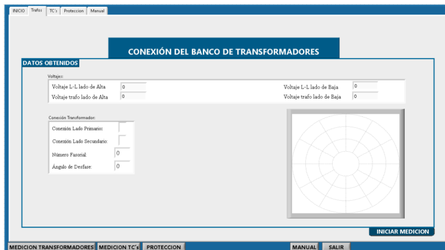
Figura. 86 Pantalla para la medición de parámetros de Transformadores.
