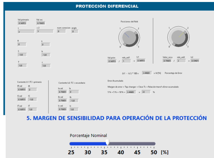
Figura. 103 Selección de la posición del relé y margen de error obtenido para una conexión Yy0.
