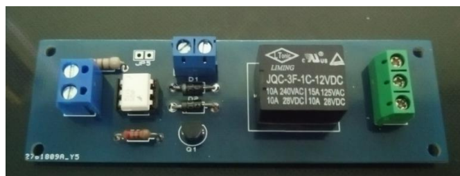
Figura. 74 Circuito optoacoplador para activación de protección.
