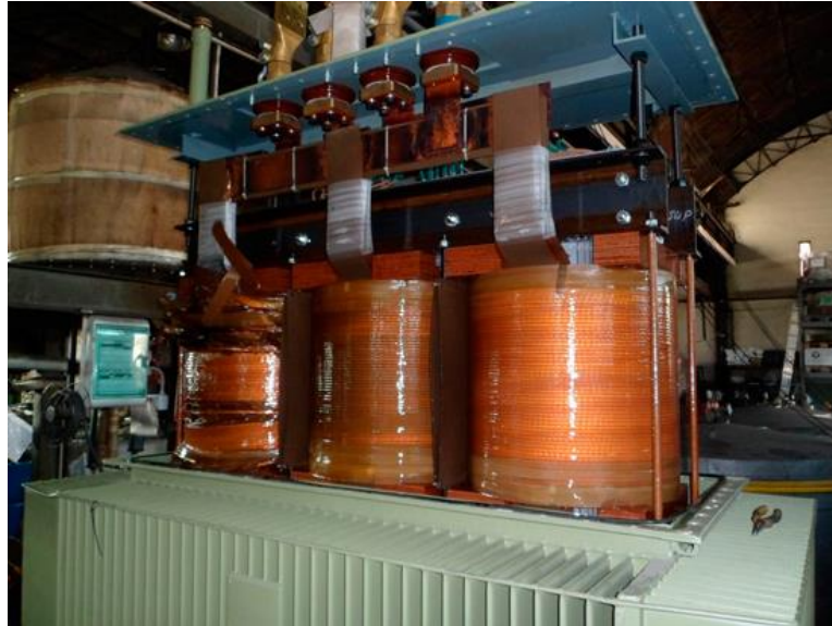
Figura. 4 Devanados de cobre en transformador trifásico. [7]
