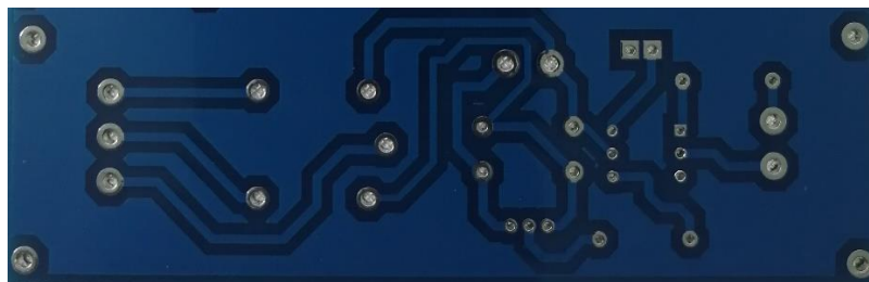
Figura. 33 Circuito impreso para activación de protección parte posterior.
