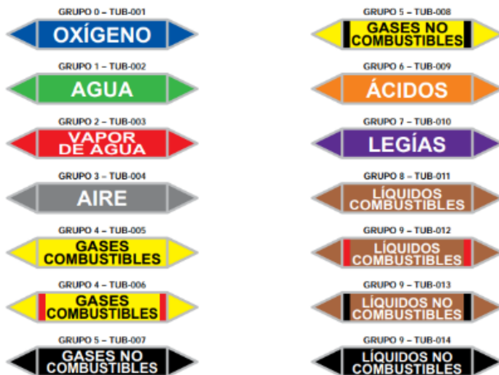
Gráfico 11 Señalética de tuberías
