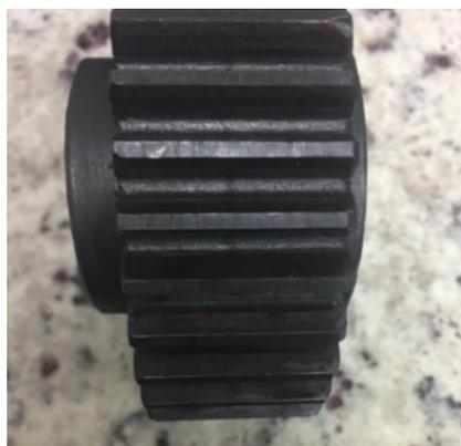
**Figura 74** Rueda dentada con tratamiento térmico cementado después de 24 horas de trabajo.
