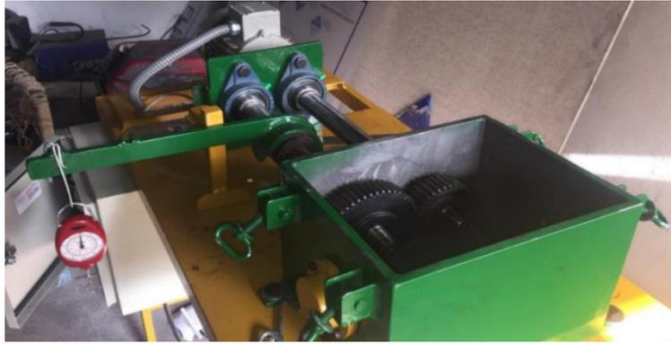
**Figura 94** Máquina de ensayo de engranajes rectos sometidos a fatiga.
