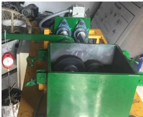
**Figura 113** Máquina de ensayo de engranajes rectos sometidos a fatiga.
