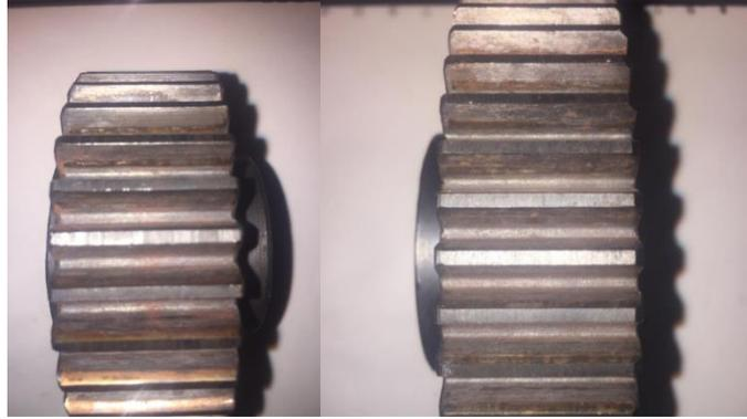
**Figura 116** Piñón y engranaje con tratamiento térmico después de 96 horas de trabajo.
