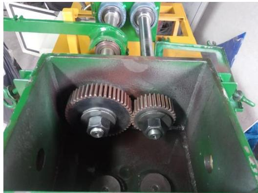
**Figura 115** Engranajes con tratamiento térmico sometido a 96 horas de trabajo.
