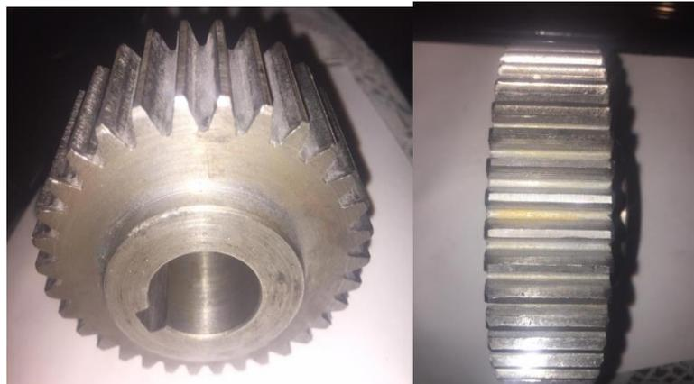
**Figura 119** Piñón y engrane sin tratamiento térmico después de 96 horas de trabajo.
