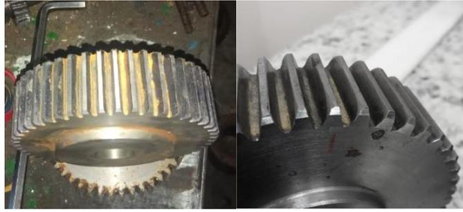
**Figura 54** Engranaje terminado después del fresado.
