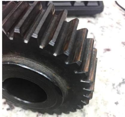
**Figura 97** Piñón con tratamiento térmico después de 48 horas de trabajo.
