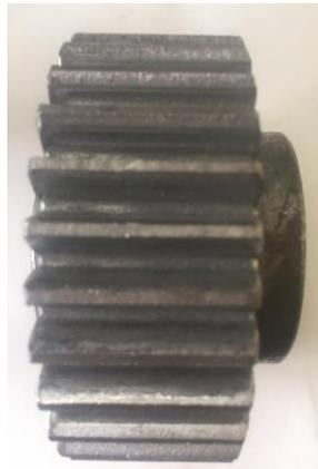
**Figura 99** Engranaje sin tratamiento térmico después de 48 horas de trabajo.
