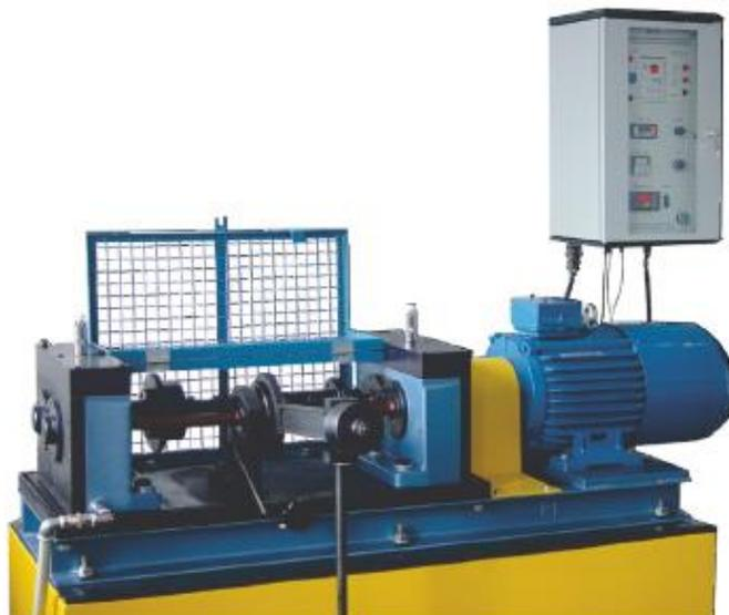
**Figura 18.** Máquina de ensayos FZG [44]
