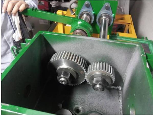
**Figura 98** Engranajes sin tratamiento térmico después de 48 horas de trabajo.
