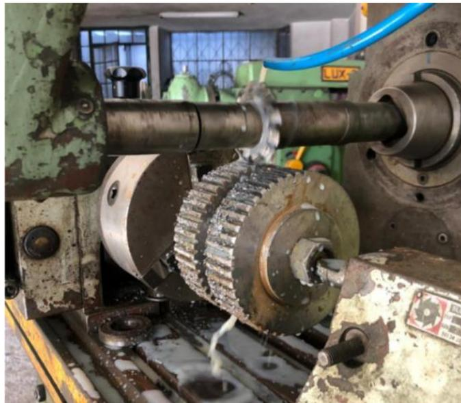
**Figura 53** Fresado de engranajes.
