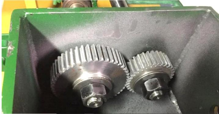
**Figura 75** Engranajes sin tratamiento térmico con 24 horas de trabajo.
