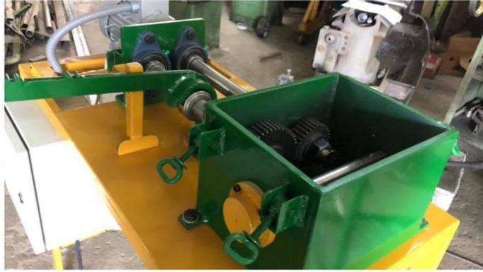
**Figura 72** Máquina de ensayo de engranajes rectos sometidos a fatiga.
