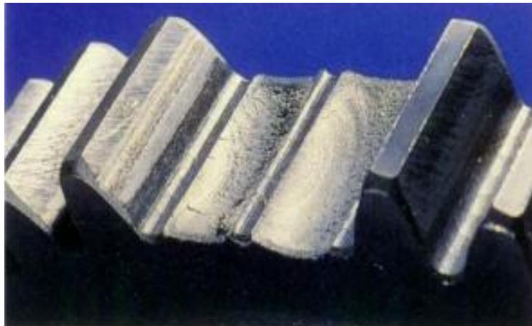
**Figura 8.** Fractura de engranaje por fatiga [23]
