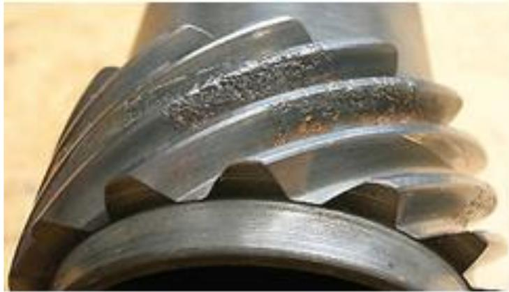
**Figura 2.** Desgaste por adhesión [6]
