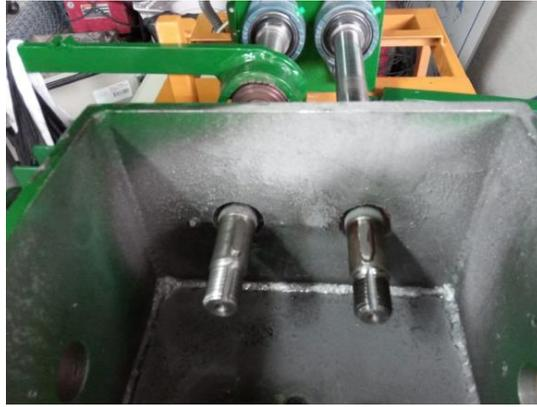
**Figura 118** Caja de engranajes después de que los engranajes sin tratamiento trabajen 96 horas.
