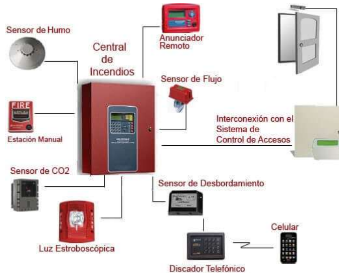
Figura 8 Sistema de incendio direccionable
