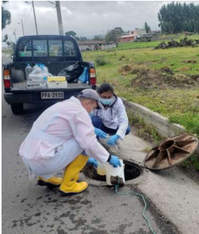
Anexo 5. Toma de la muestra de agua residual
