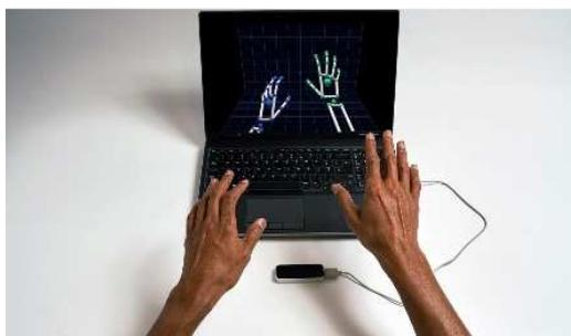
Figura 8. *Dispositivo Leap Motion e interfaz de usuario.*
