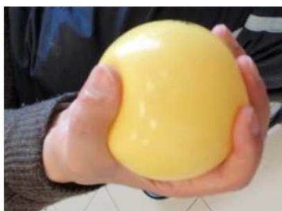
Figura 4. *Dispositivo esférico para medición de fuerzas de agarre.*
