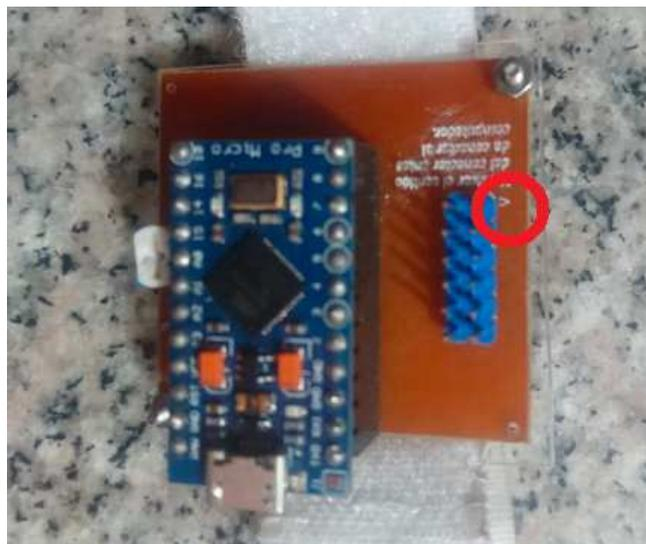
Figura D3. Triángulo o flecha que indica el sentido de la conexión.
