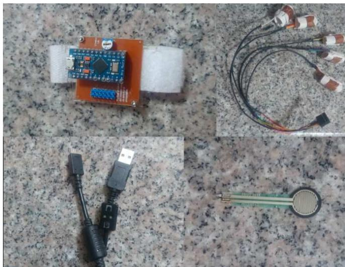
Figura D1. Componentes necesarios para poder utilizar el dispositivo. De izquierda a derecha en sentido horario: manilla con la placa de adquisición, dedos con los cables de conexión, sensor resistivo que se coloca en el dedo pulgar, cables USB de conexión.
