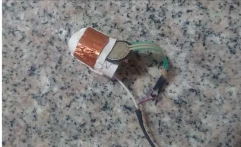
Figura D2. Dedal en donde se conecta el sensor de fuerza resistivo (FSR).
