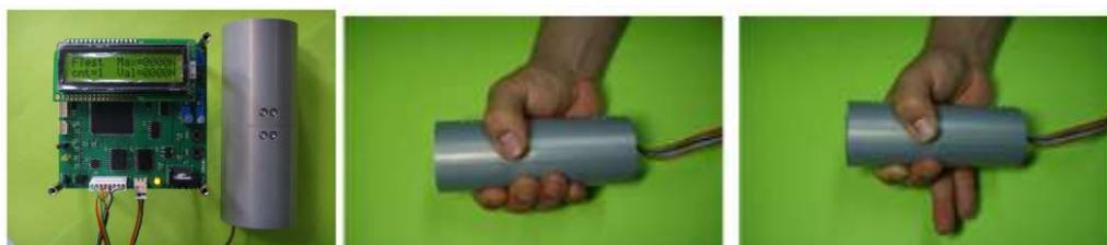
Figura 3. *Dispositivo cilíndrico para medición de fuerzas de agarre.*
