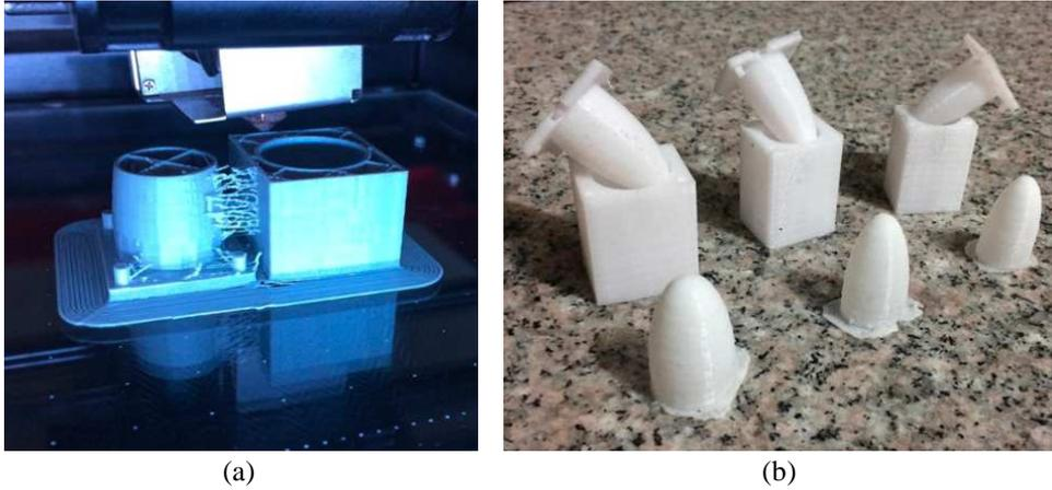
Figura 20. (a) *Impresión de las matrices;* (b) *Dedales de caucho silicón obtenidos de las matrices.*
