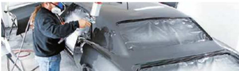
*Figura 2.* Aplicación de pintura de acabado
