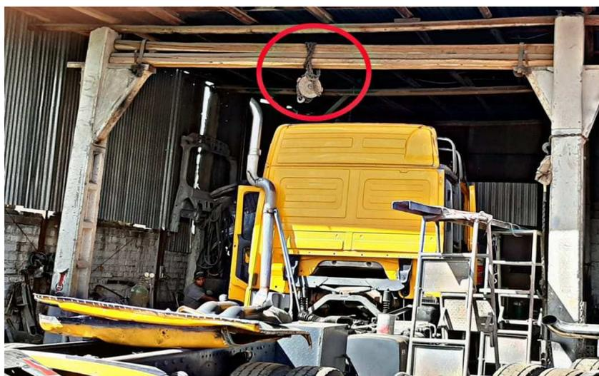
*Figura 21. Teclc de elevación*
