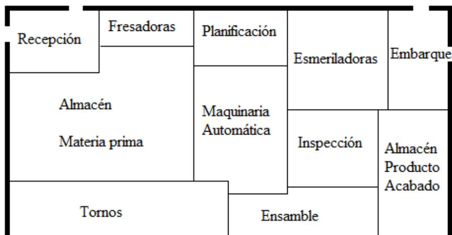
*Figura 11.* Esquema distribución de planta por proceso
