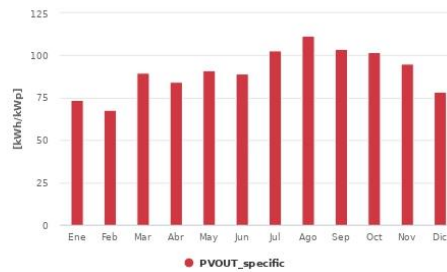
Figure 5.1: Producción fotovoltaica específica
