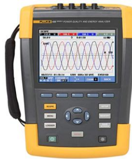
Figura 1.b: Analizador de calidad de energía eléctrica (Fluke 435).
