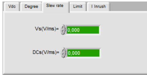
Figura 4-25: Configuración de la velocidad de respuesta del voltaje de salida en CA y CD. FUENTE: Software SoftPanel de Chroma.
