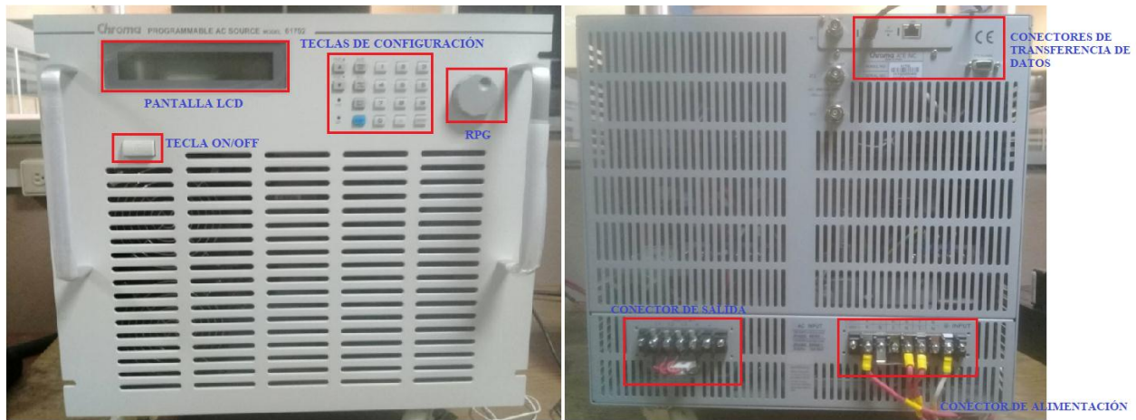
Gráfica 2: Partes de la fuente AC. (a) Panel frontal. (b) Panel posterior. FUENTE: Autor.
