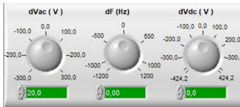
Figura 4-49: Configuración de parámetros para cada paso de la forma de onda. FUENTE: Software SoftPanel de Chroma.
