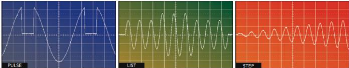
Figura 4-5: Funciones PULSE, LIST, STEP de la fuente AC programable. FUENTE: [22].
