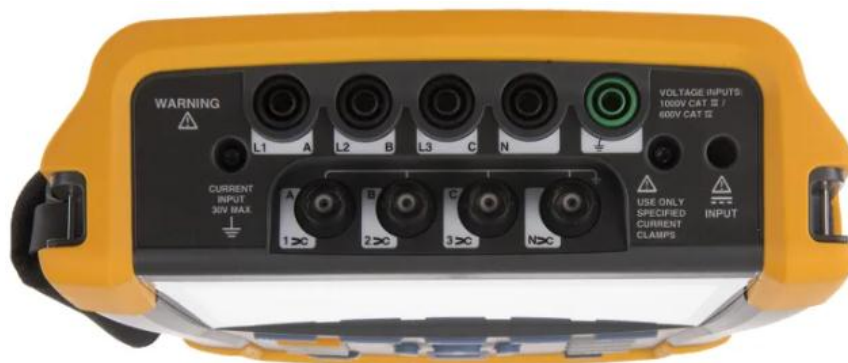
Figura 4-80: Entradas para tensión y corriente. FUENTE: [24].
