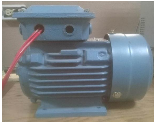
Gráfica 6: Motor trifásico de 0.5 HP. FUENTE: Autor.
