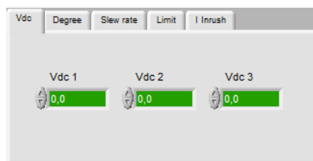
Figura 4-23: Configuración del voltaje CC. FUENTE: Software SoftPanel de Chroma.
