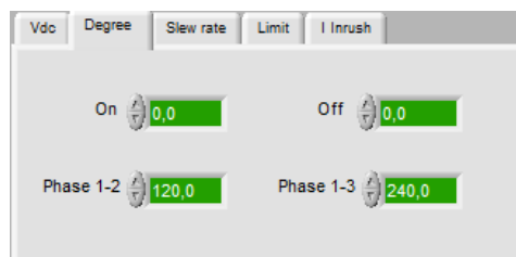
Figura 4-24: Configuración del ángulo de fase entre las líneas. FUENTE: Software SoftPanel de Chroma.
