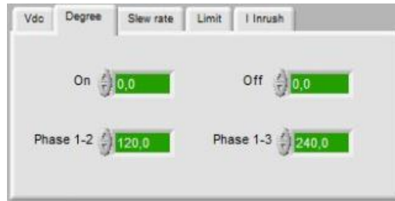
Gráfica 68: Detalle del panel para la configuración de ángulo de fase. FUENTE: Software SoftPanel.
