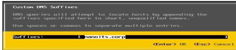
Figura 77 Dominio del hipervisor del servidor HP PROLIANT ML310e Gen8 V2.
