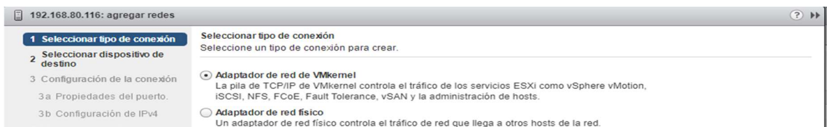
Figura 47 Creación de un switch virtual en el servidor DELL Power Edge R710.
