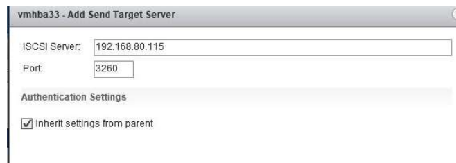
Figura 112 Presentar sistema de almacenamiento al servidor virtual HP PROLIANT ML310e Gen8 v2.
