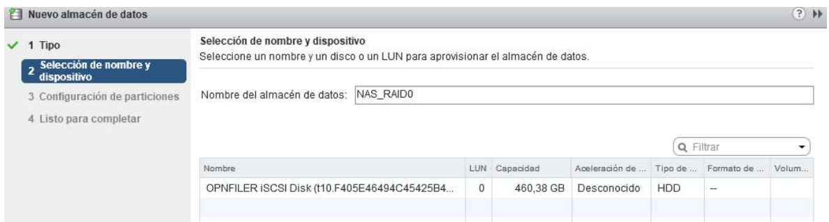
Figura 114 Creación de nuevo almacén de datos con la LUN del sistema de almacenamiento compartido en red.
