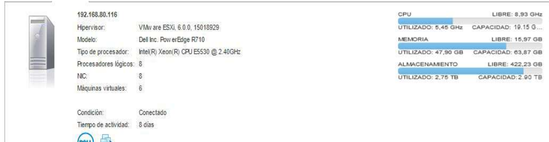
Figura 123 Estado inicial del servidor DELL POWER EDGE R710.
