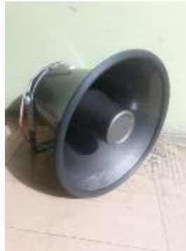
Figura 3.14 Bocina tipo corneta utilizada para la dispersión de aves por ultrasonido
