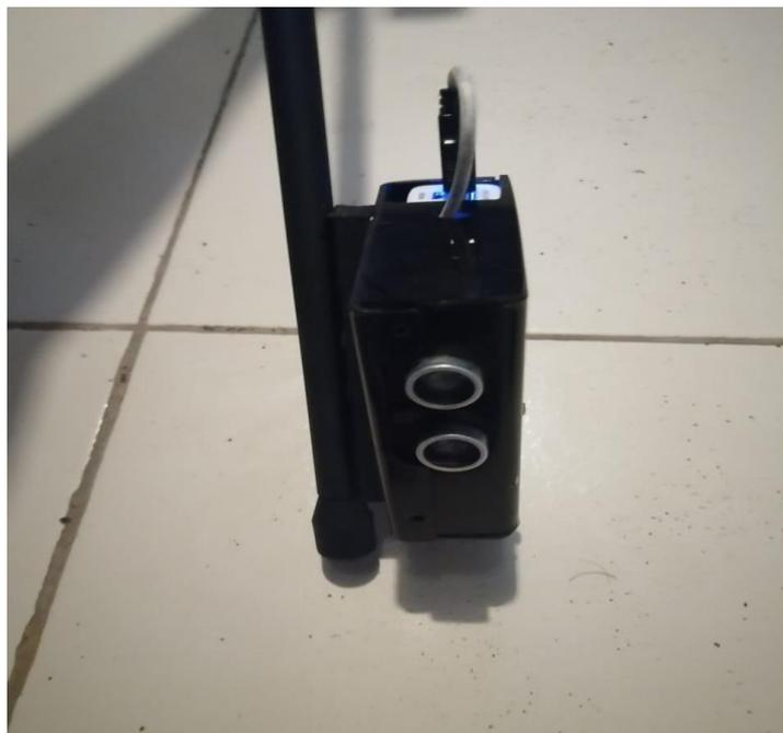
Figura 30 Vista frontal sensor ultrasónico
