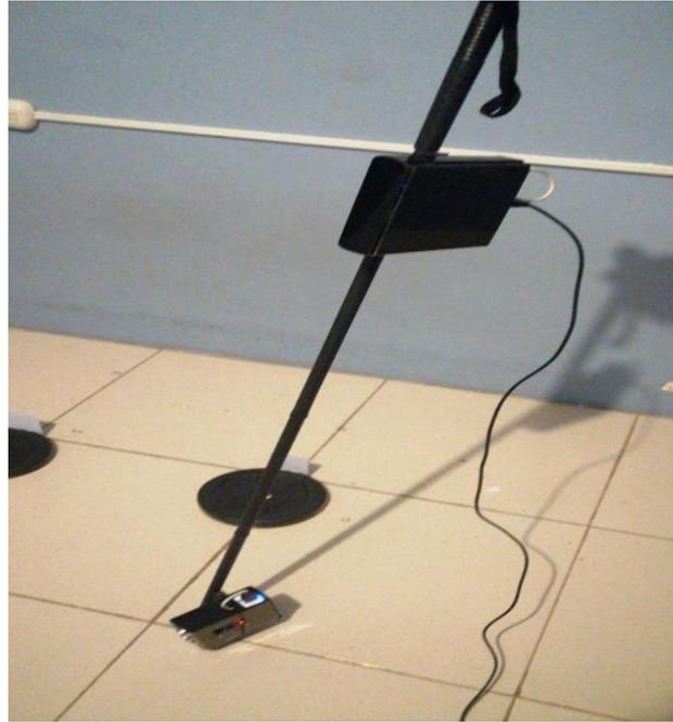
Figura 29 Vista lateral sensor ultrasónico
