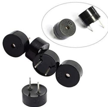
Figura 13 Tipos de Buzzer
