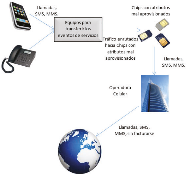
Gráfico 5 Esquema usado para el bypass telefónico
