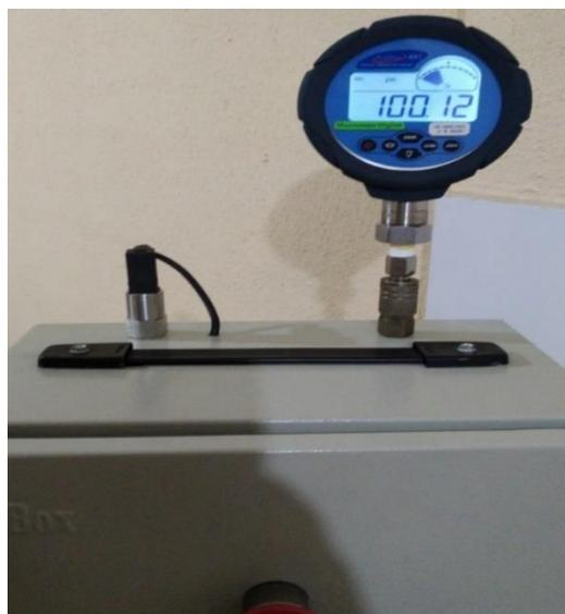
Figura 101. Valor de Patrón de presión a 80 PSI . (Los Autores).
