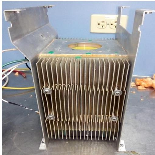
Figura 27. Acabado final de estructura de pozo de temperatura. (Los Autores).
