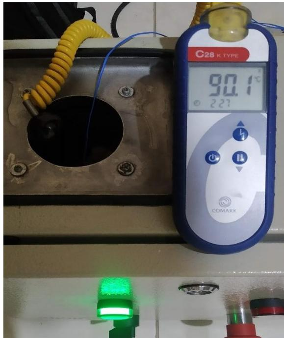
Figura 86. Valor de Patrón de temperatura a 90.1° C. (Los Autores).
