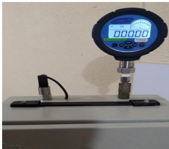
Figura 91. Valor de Patrón de presión a 0 psi . (Los Autores).
