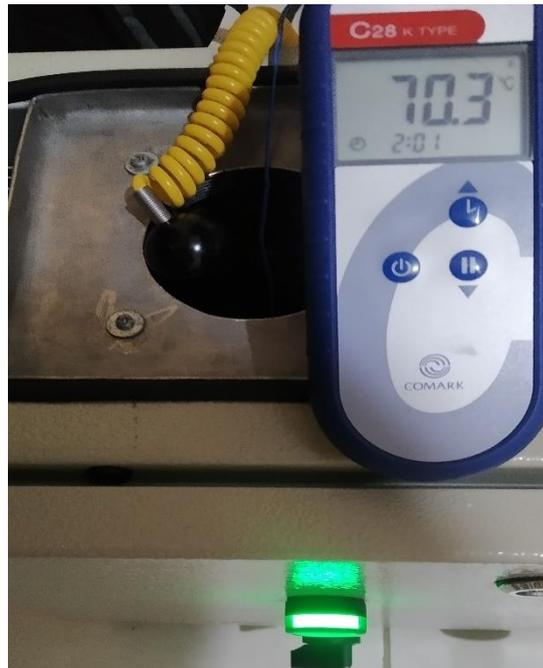
Figura 82. Valor de Patrón de temperatura a 70.3° C . (Los Autores).
