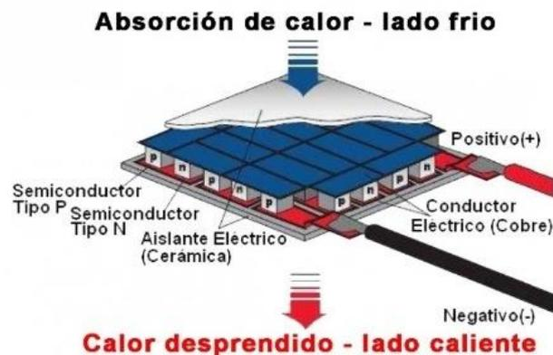
Figura 4. Célula Peltier (Digital, n.d.)
