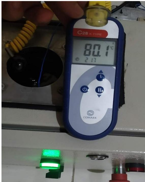
Figura 84. Valor de Patrón de temperatura a 80.1° C . (Los Autores).
