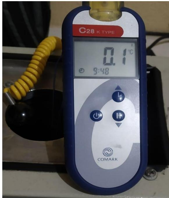
Figura 68. Valor de Patrón de temperatura a 0°C. (Los Autores).
