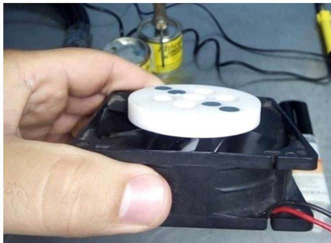
Figura 25. Disco de Agitación acoplado a ventilador. (Los Autores).
