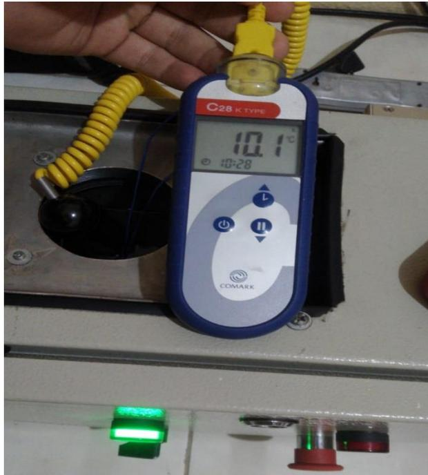
Figura 70. Valor de Patrón de temperatura a 10°C .
