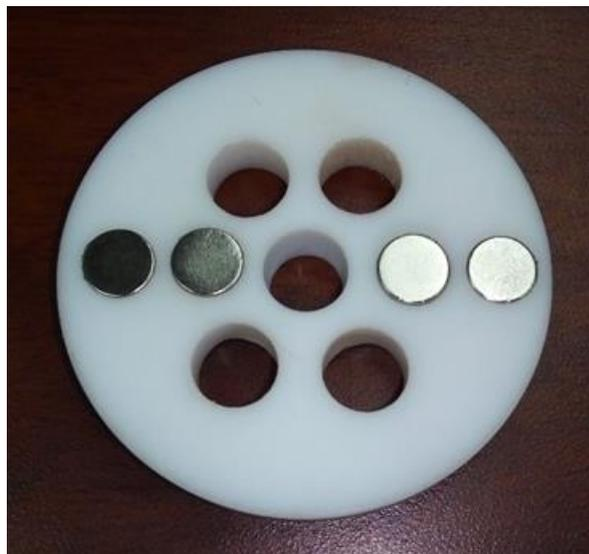
Figura 23. Disco de Nylon para Agitador de Pozo. (Los Autores).
