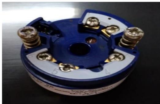
Figura 38. Transmisor de Temperatura.
