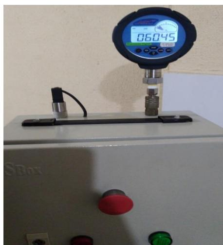
Figura 97. Valor de Patrón de presión a 60 psi . (Los Autores).
