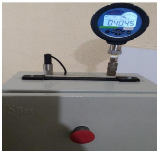
Figura 95. Valor de Patrón de presión a 40 PSI . (Los Autores).
