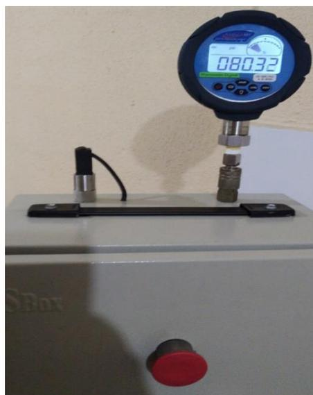
Figura 99. Valor de Patrón de presión a 80 psi. (Los Autores).
