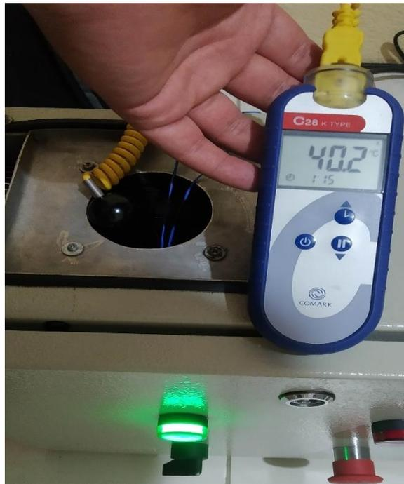
Figura 76. Valor de Patrón de temperatura a 40,2°C . (Los Autores).
