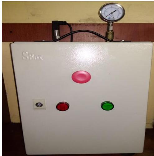
Figura 36. Tablero de planta de calibración de presión. (Los Autores).
