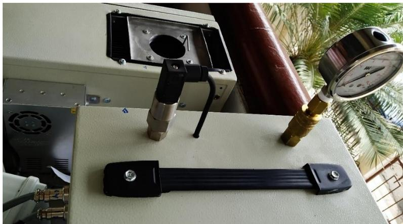
Figura 35. Instrumentos patrones planta de calibración de presión. (Los Autores).
