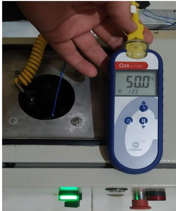
Figura 78. Valor de Patrón de temperatura a 50.0°C. (Los Autores).
