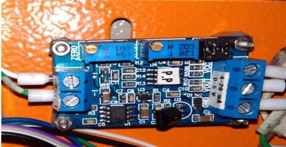
Figura 39. Modulo convertidor de Corriente a Voltaje. (Drok, 2017)
