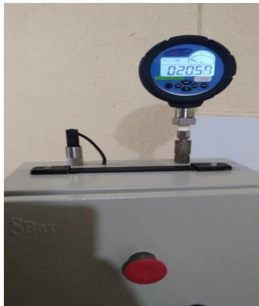
Figura 93. Valor de Patrón de presión a 20 PSI . (Los Autores).
