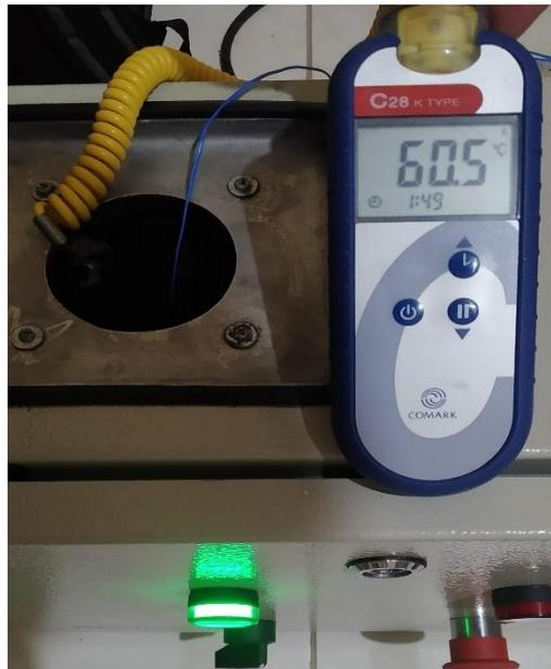
Figura 80. Valor de Patrón de temperatura a 60.5° C . (Los Autores).
