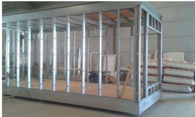
Figura 11. Estructura modular de acero [33]
