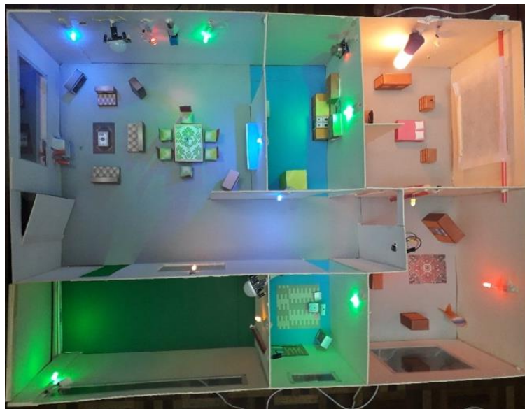
Figura 38. Distribución de todos los focos en la maqueta. Elaborado por: Los autores.
