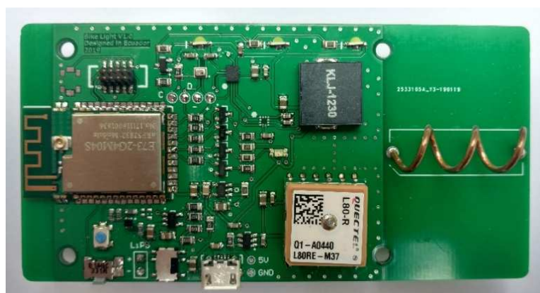
Figura 28 Vista frontal del sistema embebido de la bicicleta
