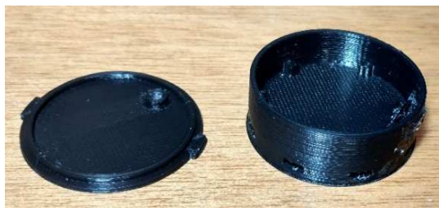
Figura 26 Carcasa de protección para sistema embebido del casco
