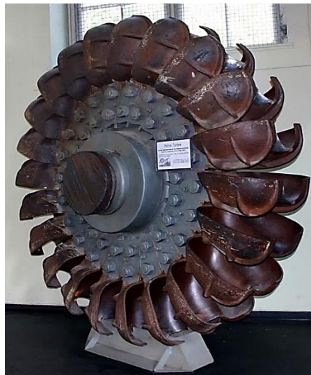
Figura 6: Turbina Peltón de la central hidroeléctrica de Walchensee en Alemania. Fuente: Wikipedia (2013). https://es.wikipedia.org/wiki/Turbina_Pelton
