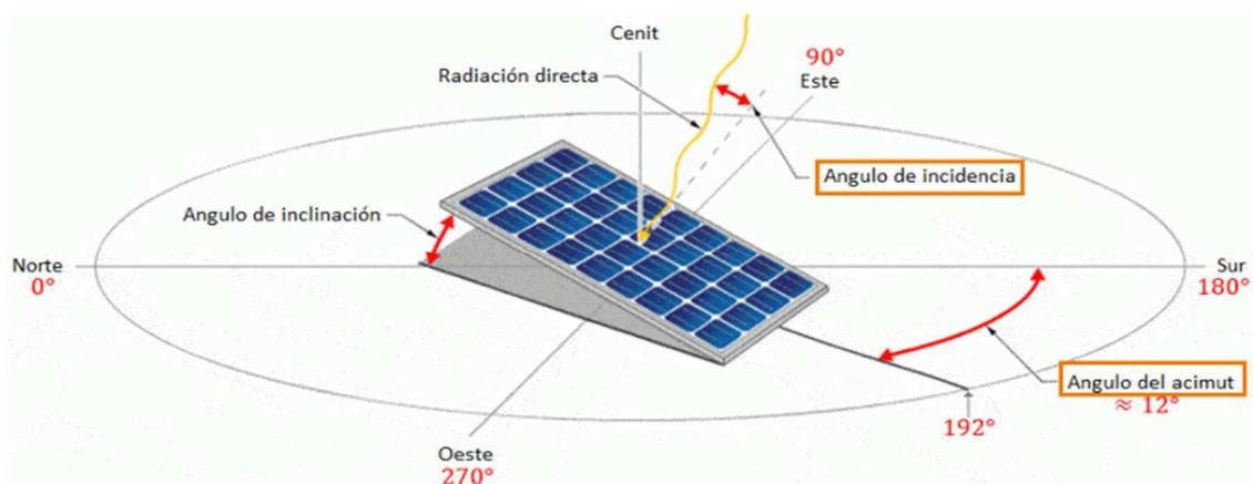
Figura 11. Ángulos referentes diseño fotovoltaico. Fuente: Tomado de [33].
