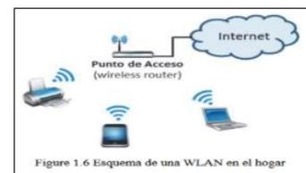
Figura 1.6 Esquema de una WLAN en el hogar. Fuente: (Baran, 2012)
