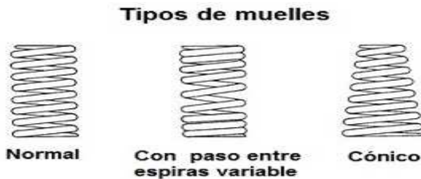
Figura 9. Diferentes tipos de resortes
