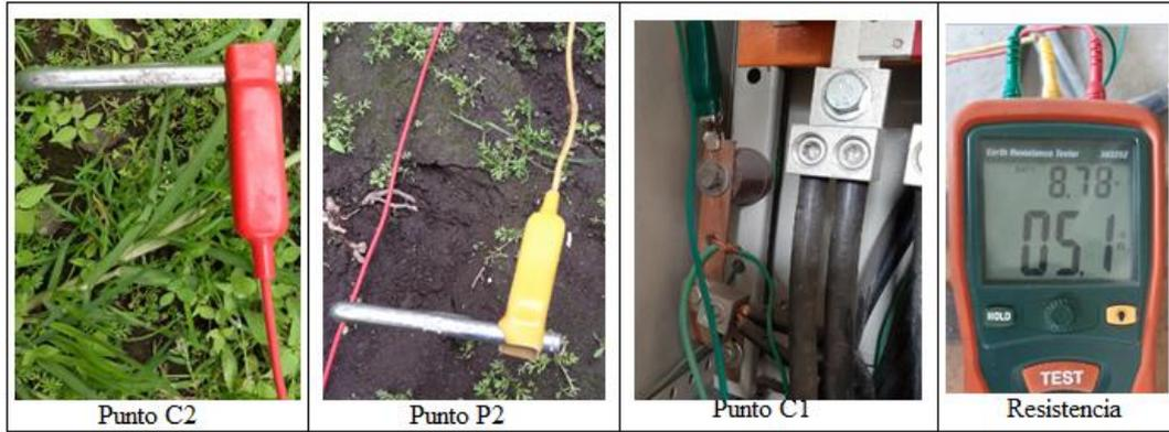
**Figura 47.** Resistencia medida del generador 1
