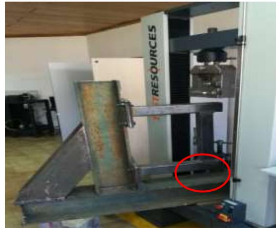
**Figura 13.** Sistema de sujeción entre la máquina universal y marco soporte.
