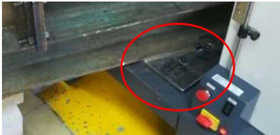
**Figura 18.** Colocación del conjunto marco soporte a la base de la máquina universal.
