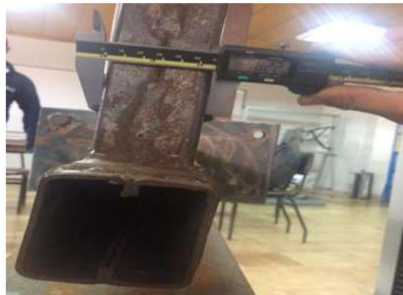
**Figura 21.** Medición con vernier del ensanchamiento de la sección transversal de los elementos de la unión soldada.
