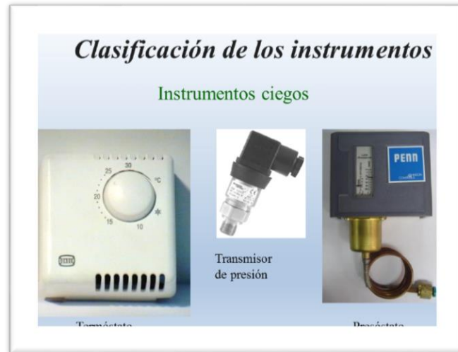
Figura 3 Instrumentos Ciegos Fuente: Gieck, K. y Gieck, R. (2003)
