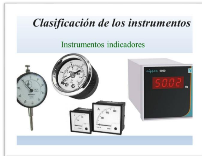
Figura 4 Instrumentos indicadores Fuente: Gieck, K. y Gieck, R. (2003)
