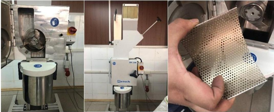
*Figura 12.* Trituradora Retsch SM 100 y malla 2mm
