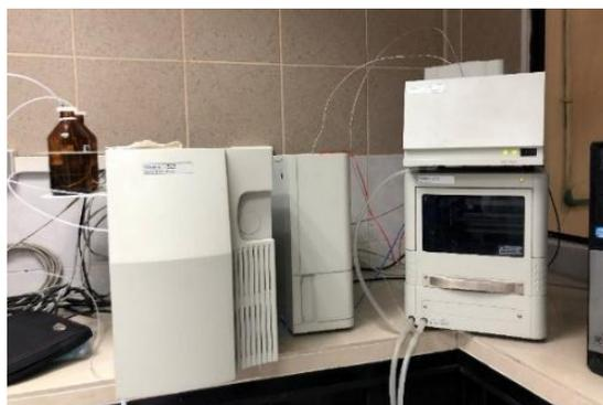
Figura 23. Cromatógrafo de líquidos de alta resolución (HPLC Breeze QS Waters 1525)
