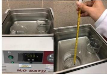
*Figura 14.* Control de temperatura del ácido en el baño térmico
