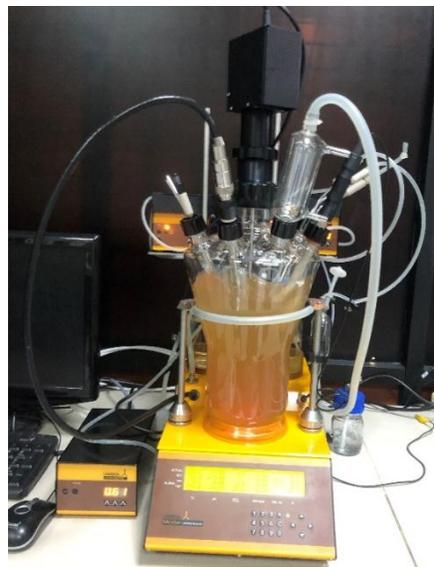
*Figura 21.* Biorreactor LAMBDA MININOFR de 3 L cargado con el medio preparado
