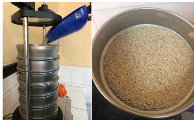
*Figura 13.* Tamizado en tamizadora Retsch AS 200
