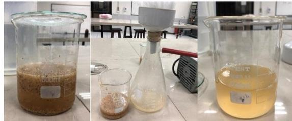
*Figura 16.* Filtrado de hidrólisis ácida de bagazo de caña
