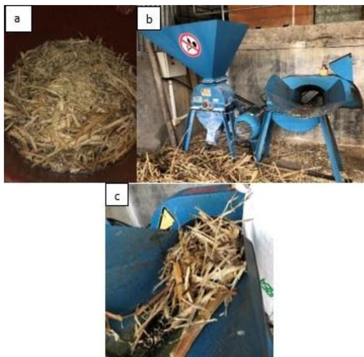
Figura 11. a) Lavado del bagazo de caña con agua, b) Picadora mecánica de la Universidad Politécnica Salesiana, c) Trituración del bagazo
