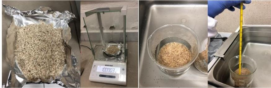
*Figura 15.* Bagazo de caña en papel aluminio para pesaje y colocación en el ácido
