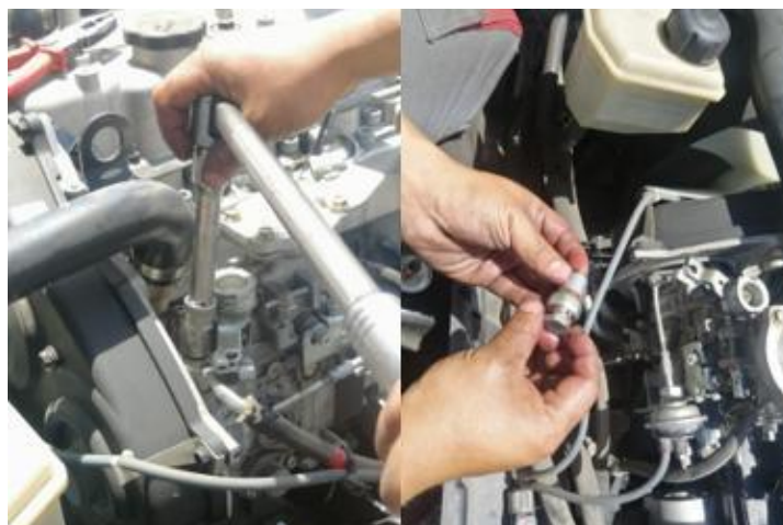
Figura 79. Retiro de resorte y filtro
