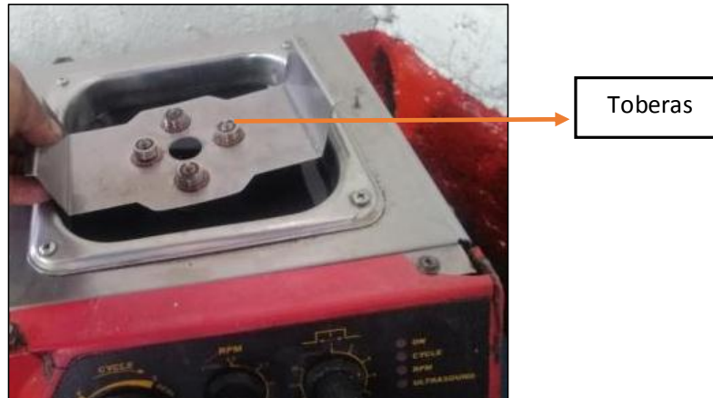
Figura 111. Limpieza de toberas en Ultrasonido.
