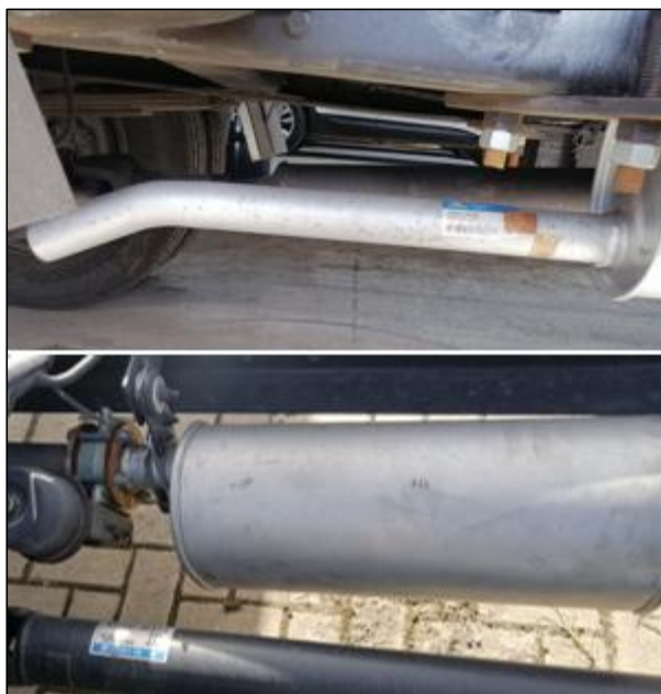
Figura 38. Verificación del tubo de escape
