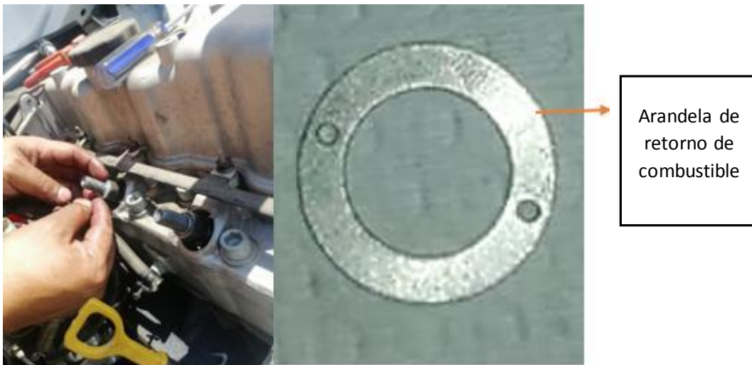
Figura 54. Arandela de retorno de combustible de inyector
