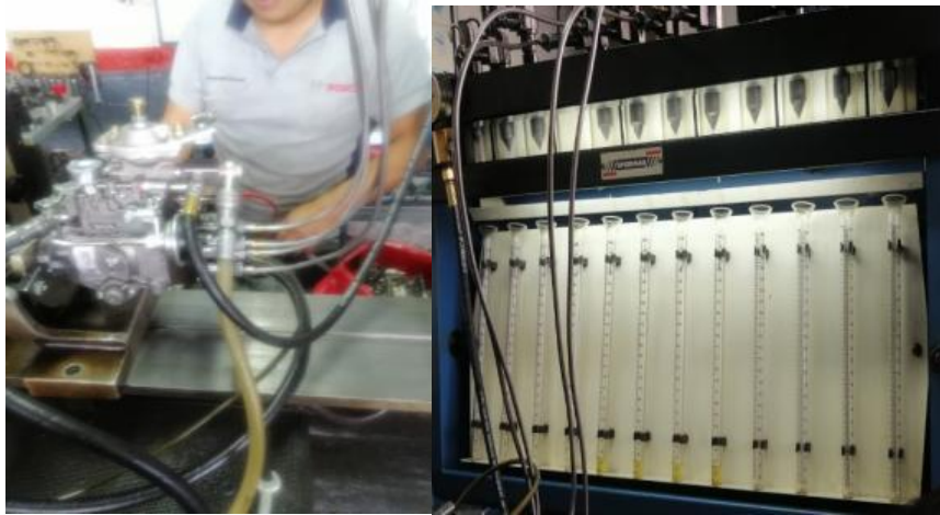
Figura 95. Conexión de cañerías de inyectores
