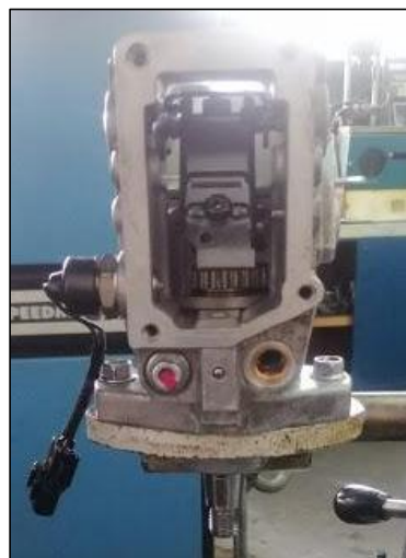
Figura 114. Bomba en la base giratoria
