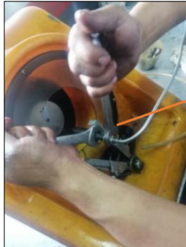
Figura 58. Ajuste de inyectores
