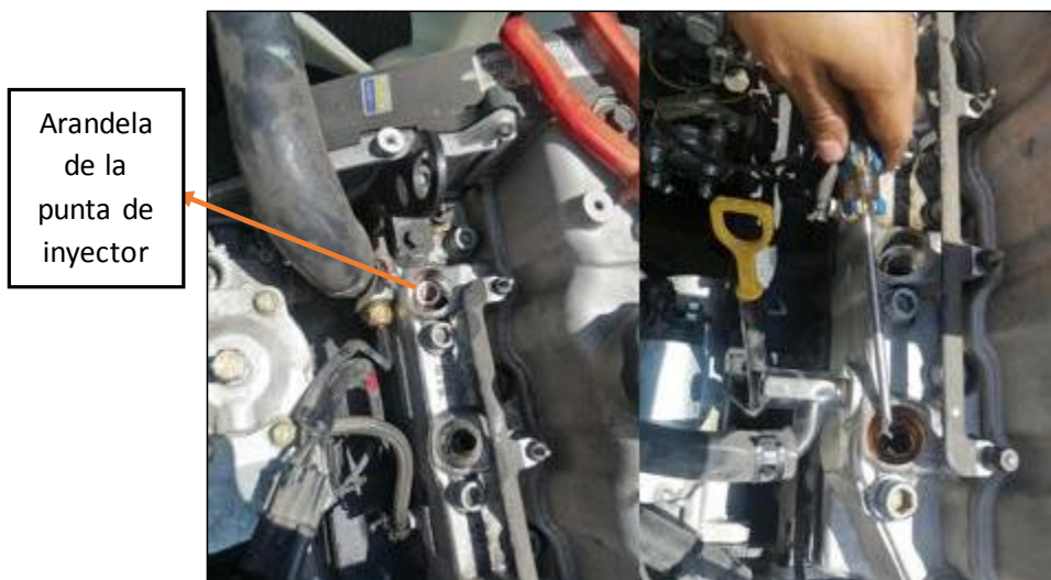
Figura 56. Desmontaje de arandelas de punta de inyectores
