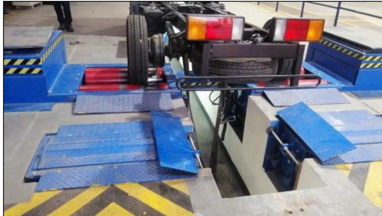
Figura 29. Centrado de llantas en los rodillos
