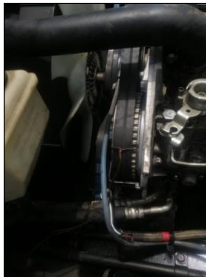
Figura 76. Inmovilización de la rueda dentada
