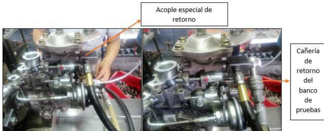
Figura 89. Conexión en banco de pruebas
