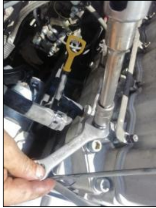
Figura 53. Desmontaje de cañería de retorno de los inyectores
