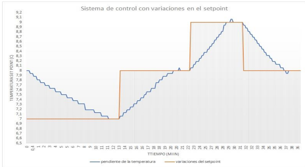
Figura 4. 1 Sistema de control con setpoint en un rango de 7 a 9 grados
