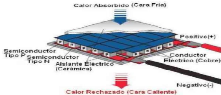
Figura 2. 4 Constitución de la Celda de Peltier
