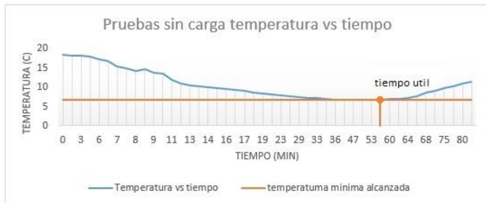
Figura 4. 3 Temperatura del sistema vs tiempo de enfriamiento del sistema sin carga
