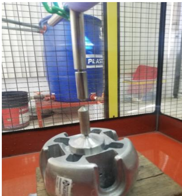
Figura 3.5 Configuración de electrodos punta-punta Fuente: Los Autores
