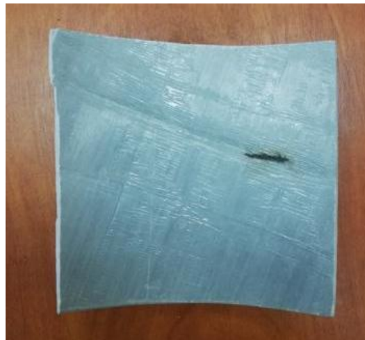
Figura 3.8 Muestra de poste PRFV con ruptura Fuente: Los Autores
