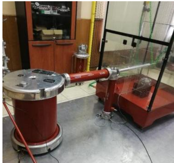
Figura 3.7 Circuito para determinar la rigidez dieléctrica Fuente: Los Autores
