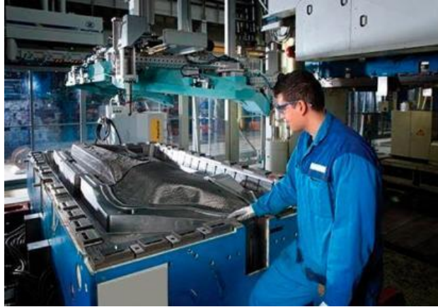
Figura 2.6 Proceso de Moldeo por Transferencia de Resina Fuente: [13]
