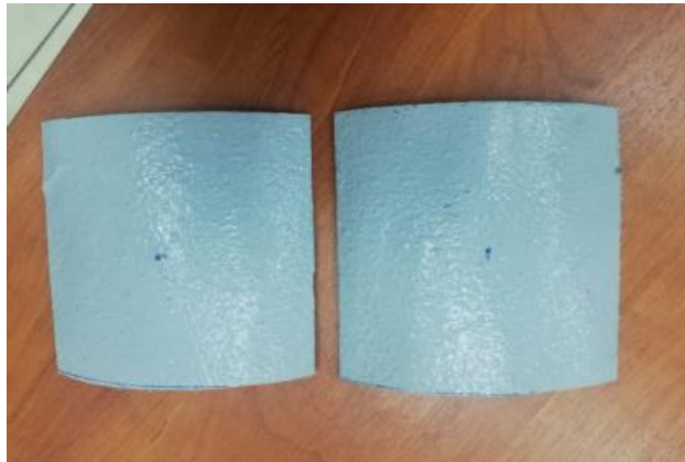
Figura 3.4 Muestras de postes PRFV Fuente: Los Autores
